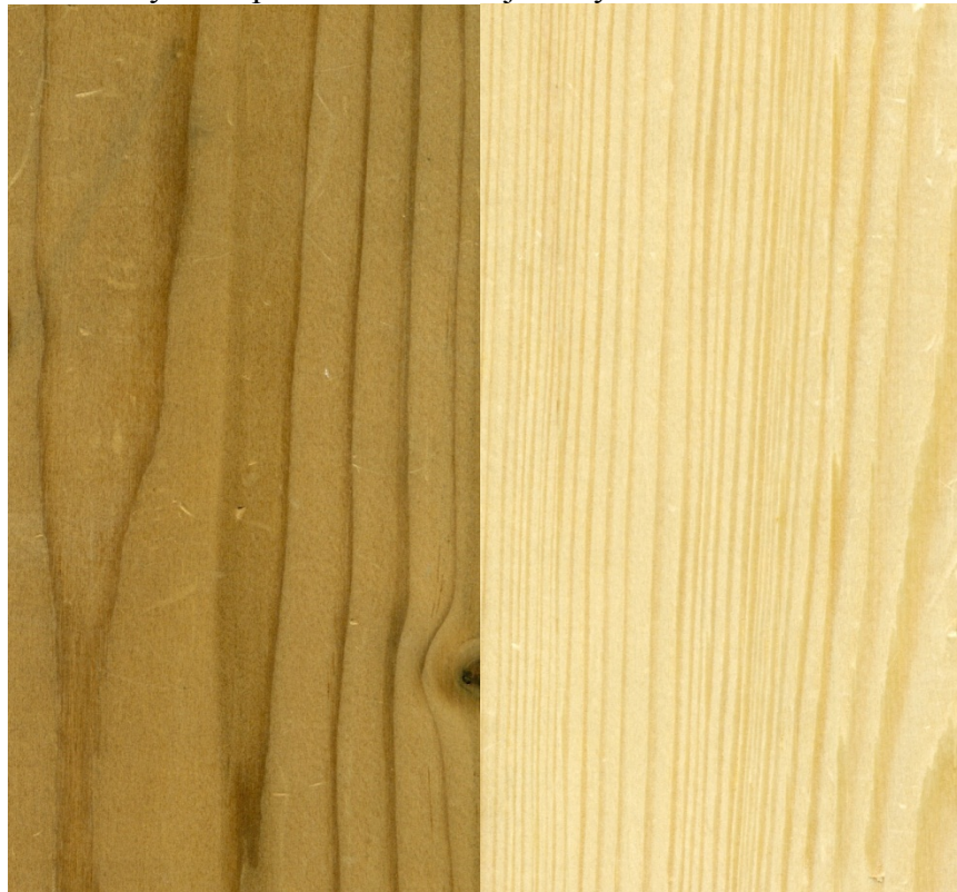
Foto 4 y 5: Aspecto del abeto rojo sin y con termotratamiento
