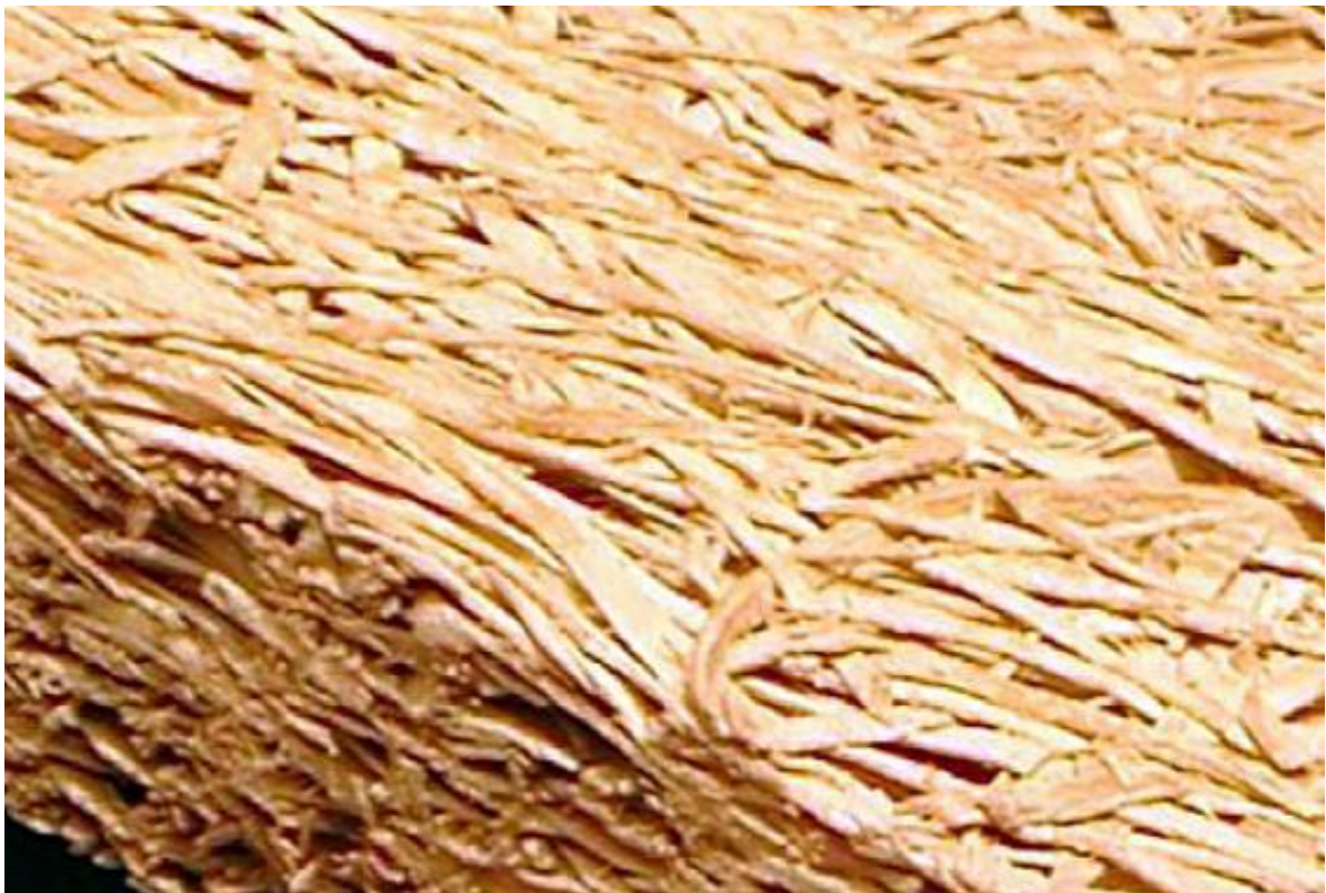
Foto 18: Tablero de viruta cemento
