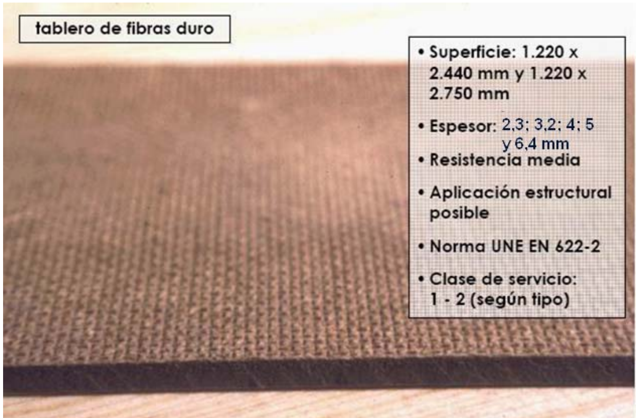
Foto 12: Tablero de fibras húmedo
