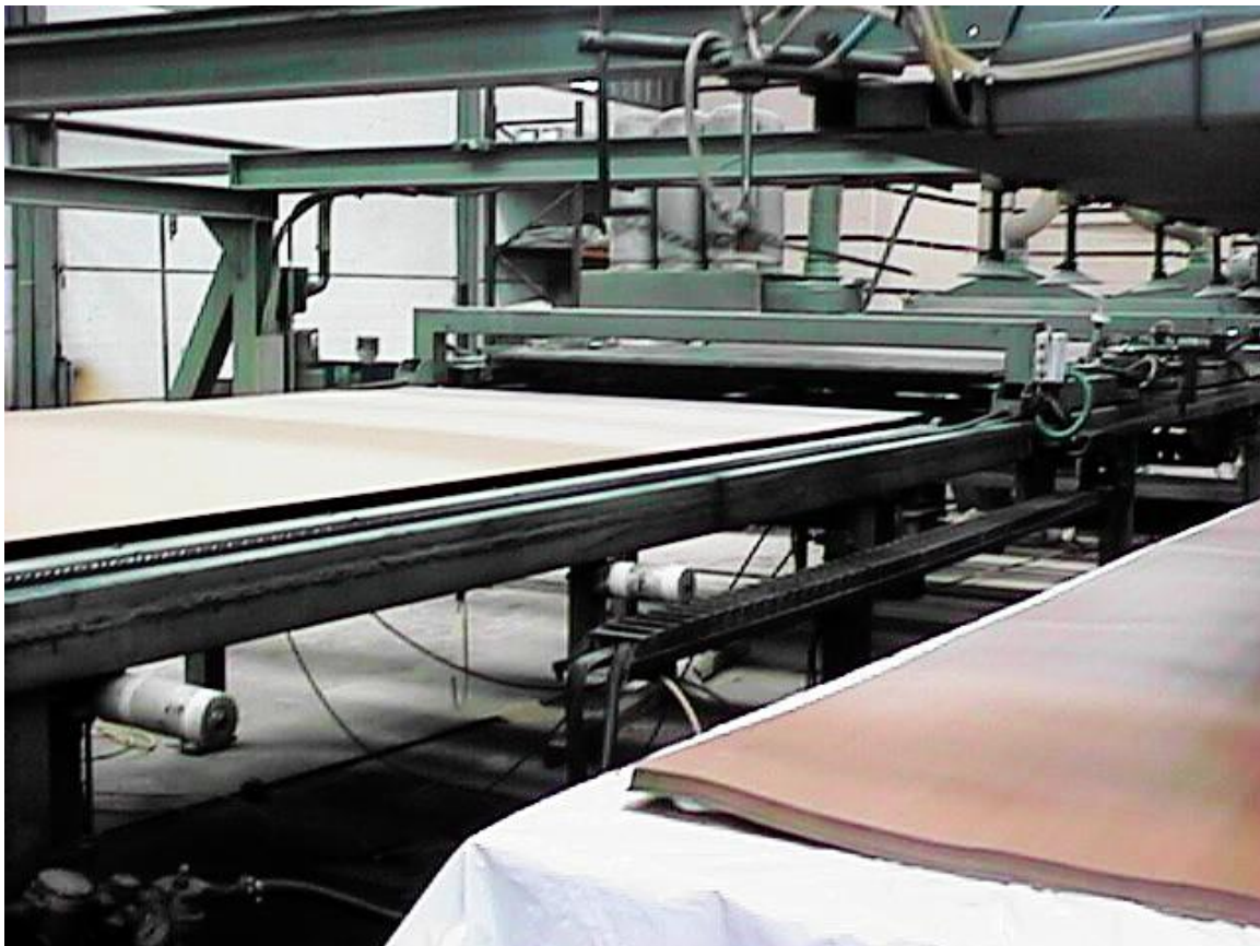
Foto 21: Recubrimiento de tableros con melamina
