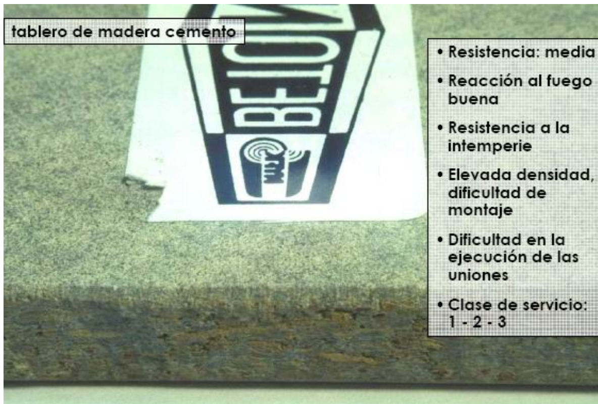
Foto 17: Tablero de madera cemento
