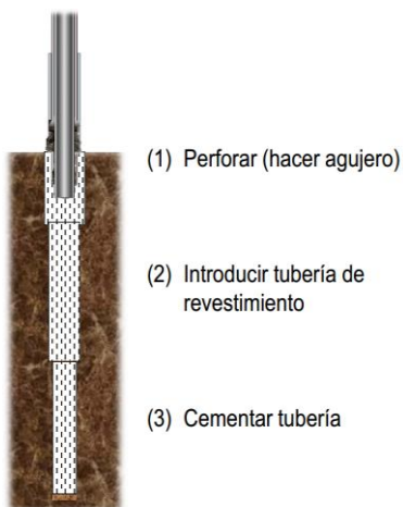
Figura 1: Etapas de perforación
