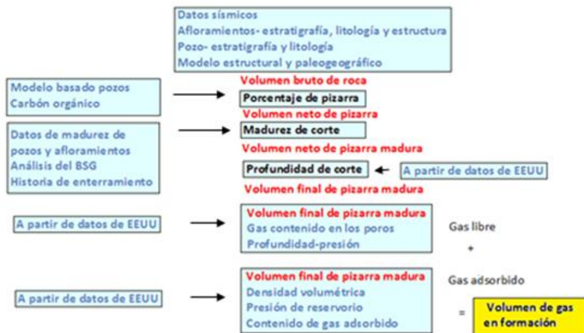
Figura 34: Datos introducidos en el modelo para determinar el volumen de gas en formación
