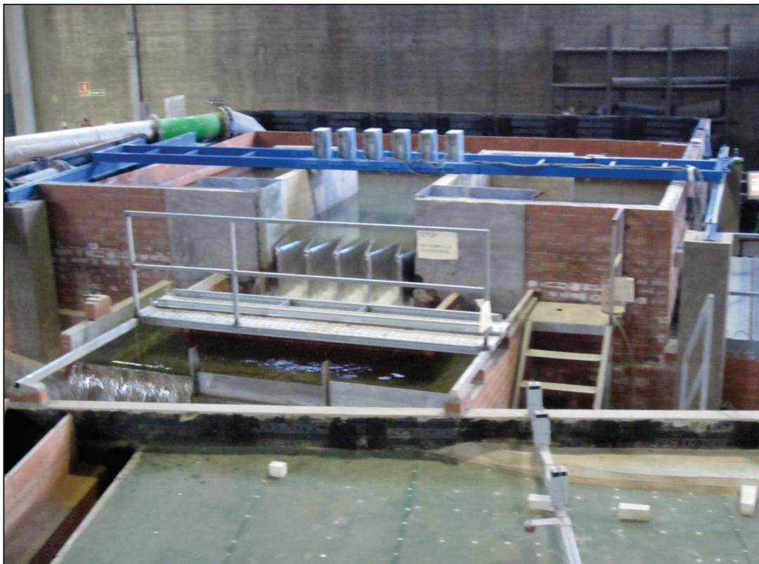
La medida del caudal se realiza mediante caudalímetro en la bomba, que ha sido previamente calibrado.
