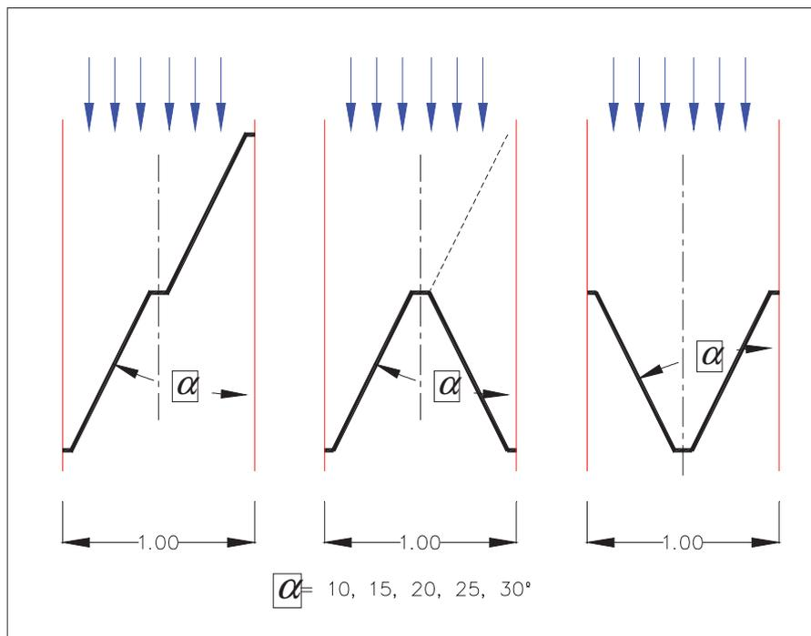
En paralelo a los ensayos físicos se va a realizar una campaña de modelaciones numéricas que se calibraran con los ensayos físicos y que permitirán extrapolar resultados a geometrías no modeladas físicamente. Finalmente, se va a proceder a introducir una variable en el diseño de los aliviaderos tipo laberinto y que es la inclinación del paramento de aguas arriba de las distintas caras del vertedero para enlazar con las denominadas geometrías en "tecla de piano".
