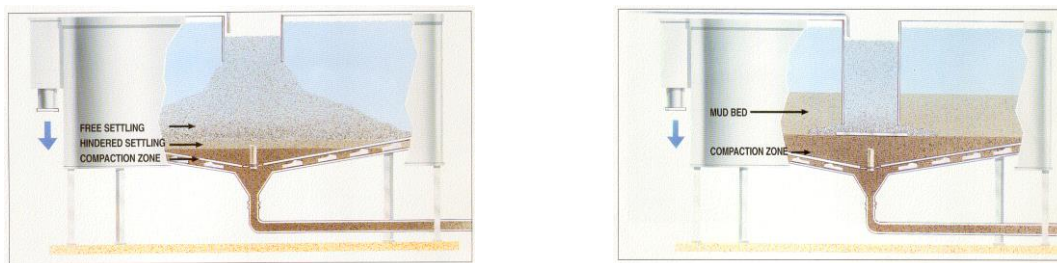
Figura 3 - Comparativa de espesador “Convencional” y “HRT”
