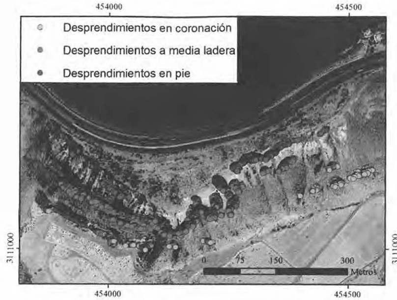
Figura 4. Potenciales áreas fuente de los desprendimientos rocosos derivadas de la clasificación del terreno realizada a partir del modelo digital de elevaciones.
