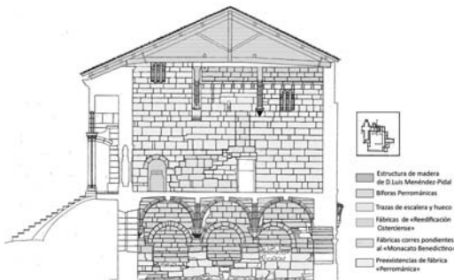
Figura 7 Sección transversal del ala oriental por la llamada Cocina de la reina: lectura de superposiciones de fábricas (dibujo de autores 2013)
