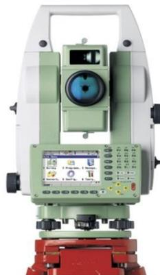
Imagen 2.4.1.2. Estación total Leica TCS 1200+
