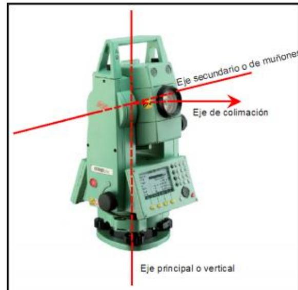
*Imagen 2.4.1.4. Eje de colimación de una estación total.*
