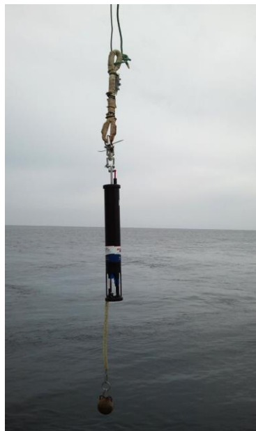
Figura 2. Perfilómetro de sonido.
