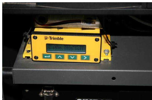
Figura 6. GPS Diferencial modelo Trimble Ag132 .
