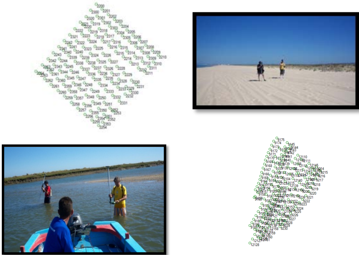
Figura 16. Levantamiento GPS en Zona de Vegetación, Arena e Intermareal (Interior de Marisma).
