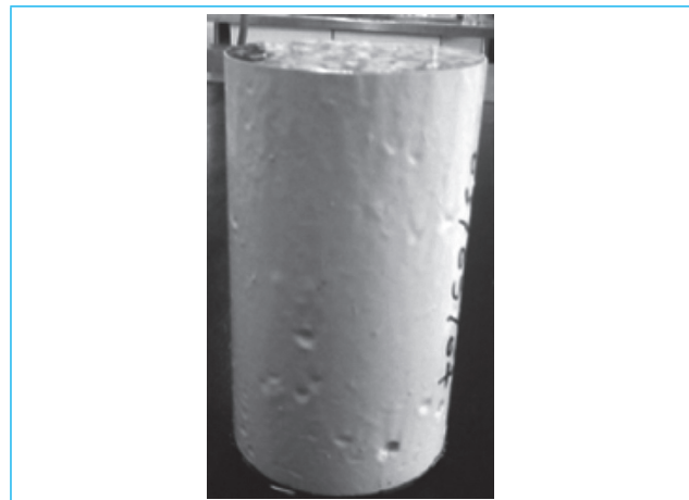
Figura 11 Probeta acondicionada previo a su inmersión en medio agresiva.
