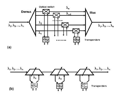
Fig. 2.- Reconfigurable OADM architectures. (a) Parallel. (b) Serial.
