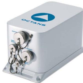
Ilustración 12: Sensor de movimientos Octans (Cabeceo, Balanceo, Rumbo y Oleaje)
