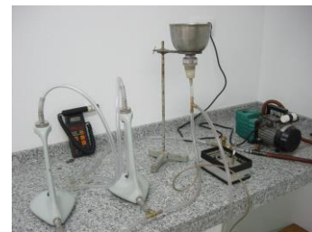
Fig. 1: Elementos del ensayo de permeabilidad de filtros de protección respiratoria
