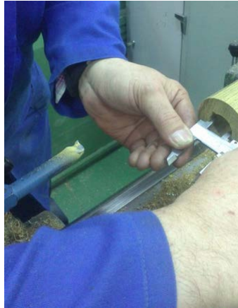
Figura 119. Medida del diámetro de 18 mm
