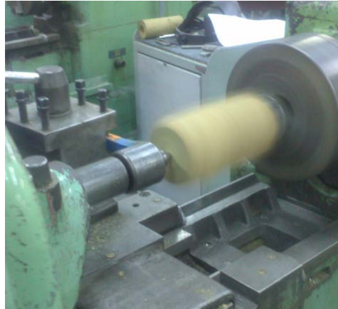
Figura 128. Cilindrado de 29mm de diámetro por 130mm de longitud
