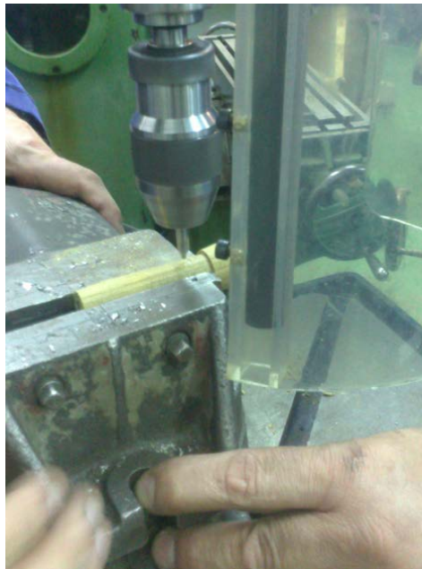
Figura 127. Taladro pasante lateral de 8 mm de diámetro
