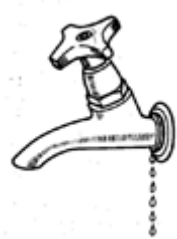
Figura 47. Goteo del grifo por la unión con la pared
