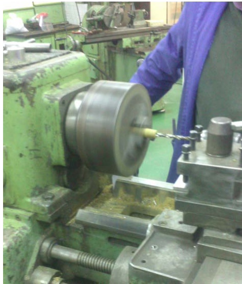
Figura 126. Taladrado a 8mm de diámetro por 65mm de profundidad
