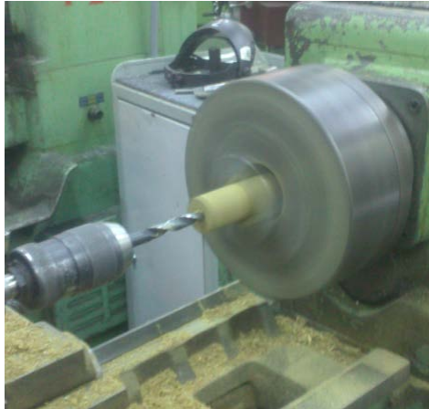
Figura 131. Taladrado de 10mm de diámetro
