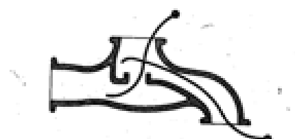
Figura 43. Forma de desatascar un grifo introduciendo un alambre
