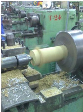
Figura 117. Cilindrado a 51 mm
