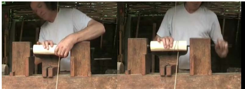
Figura 153. Fijado en el punto y en el contrapunto del torno de cuerda
