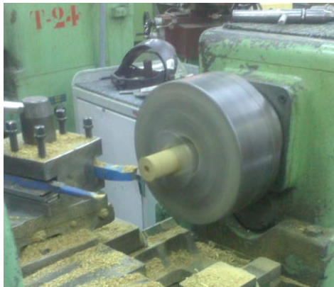
Figura 132. Rectificado de la cara
