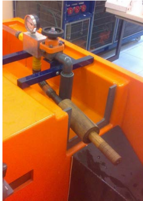
Figura 140. Grifo en el banco de pruebas
