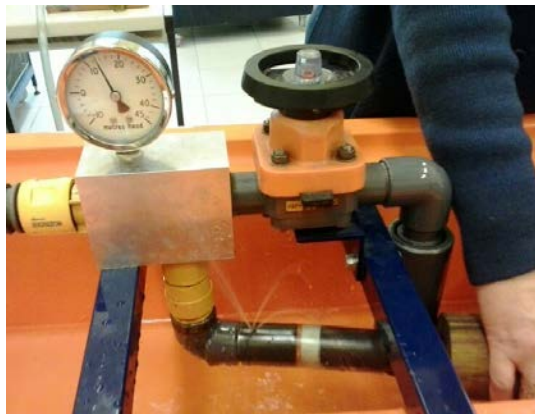
Figura 141. Grifo en el banco de pruebas
