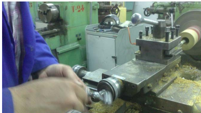
Figura 123. Tallado de los conos interiores
