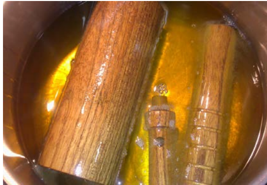
Figura 135. Baño de aceite. Temperatura 50C
