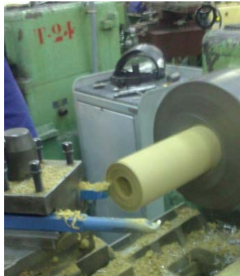
Figura 120. Rectificación de la cara exterior
