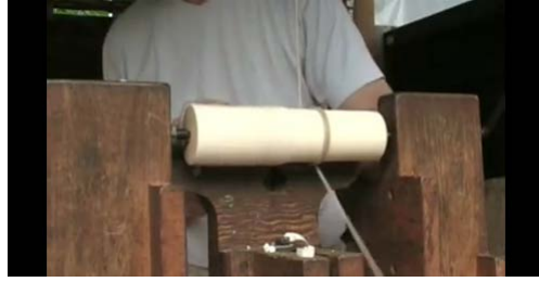
Figura 155. Cilindrado del otro extremo
