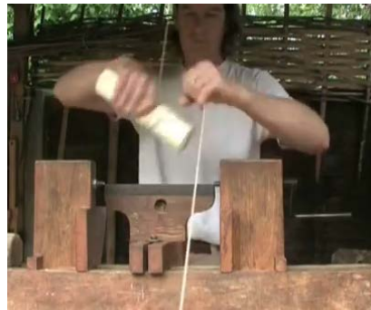
Figura 152. Enrollado de la cuerda del torno de cuerda
