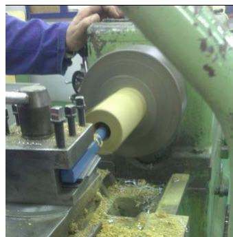
Figura 121. Cilindrado interior 31x50
