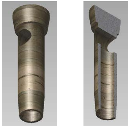
Figura 112. Vástago de accionamiento, propuesta 4 mejorada. Modelado
