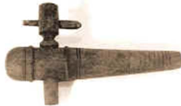
Figura 67. Grifo de madera y corcho utilizado en tonelería s. XX [40]
