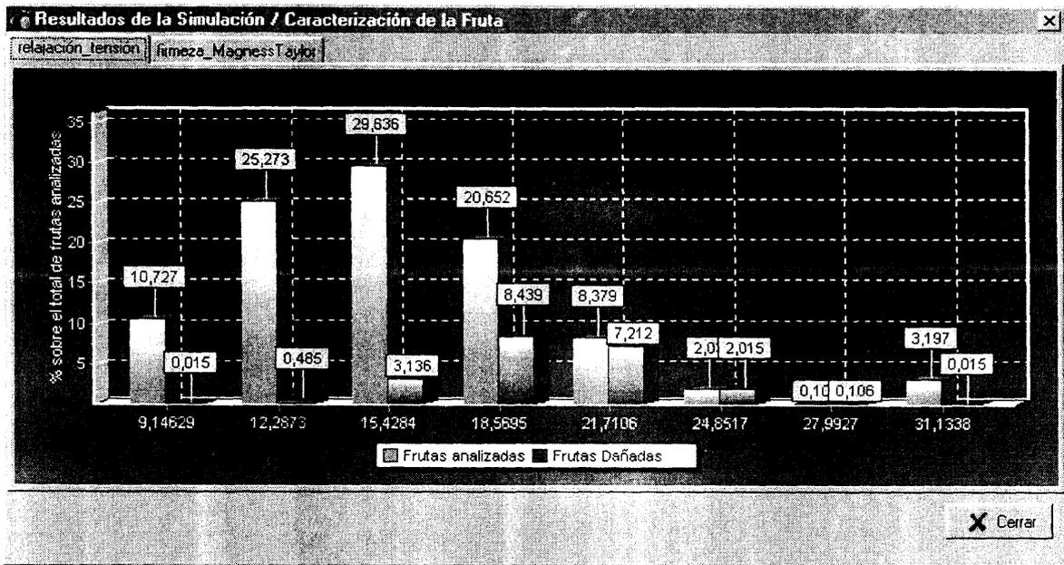
Figura 4. Desglose del porcentaje de fruto dañado según niveles de relajación de la tensión (Pa/Pa), obtenido en la manipulación de melocotón *Sudanell* heterogéneo con la. Se observa que la susceptibilidad intrínseca del producto es máxima para valores superiores al 20% de relajación de la tensión.
