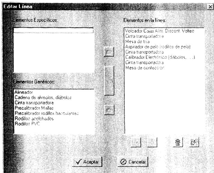
Figura 2. Generación de una línea de clasificación (ventana derecha) a partir de una base de datos de elementos específicos (ventana superior izquierda) y de elementos genéricos (ventana inferior izquierda). La herramienta dispone de rutinas lógicas para la identificación de errores.
