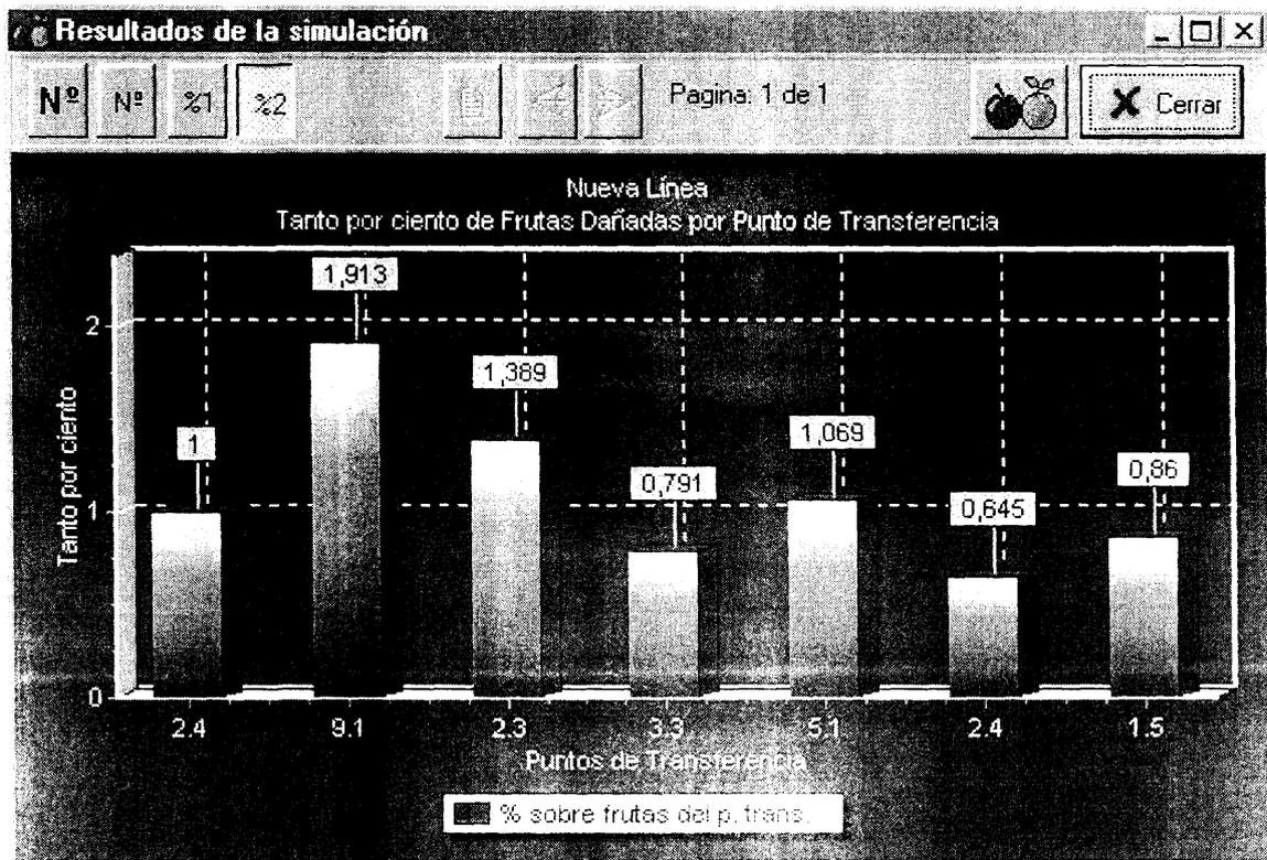
Figura 5. Desglose de daños (6% total) en los disjuntos puntos de transferencia para melocotón *Sudanell* homogéneo manipulado en la línea 3.
