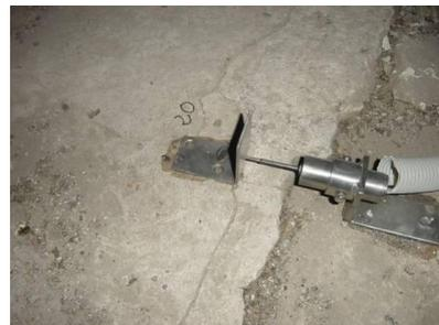
**Foto 3.-** Medida con fisurómetro
