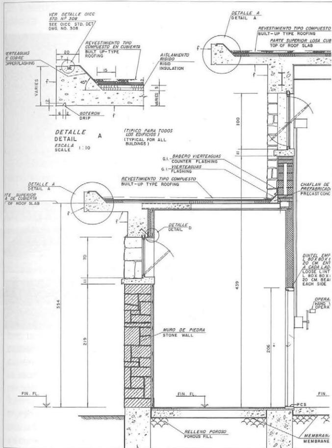
Sección constructiva. INTA-NASA.
