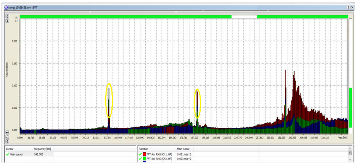
Figura 54: Análisis FFT de excentricidad. Destacar picos correspondientes a dicho fenómeno (véanse figuras 55 y 56).
