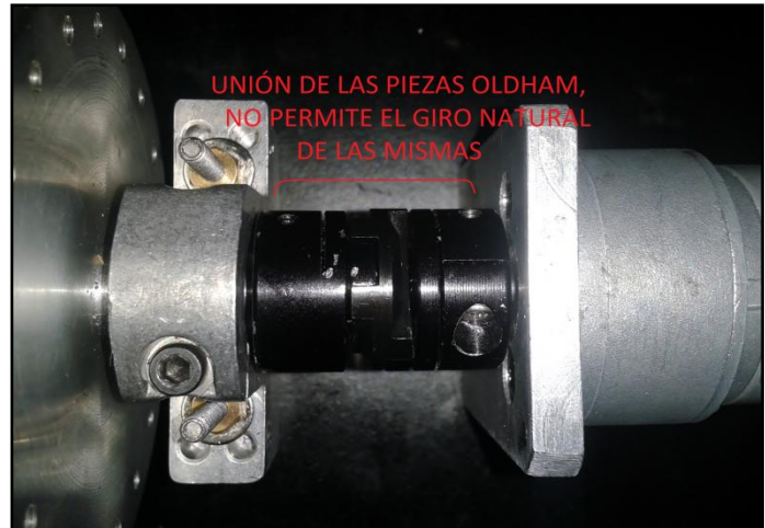
Figura 53: Detalle unión piezas Oldham para comprobación de excentricidad.
