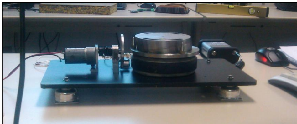
Figura 175: Análisis del sistema placa + motor tras insertar los aisladores metálicos entre la placa y la mesa.
