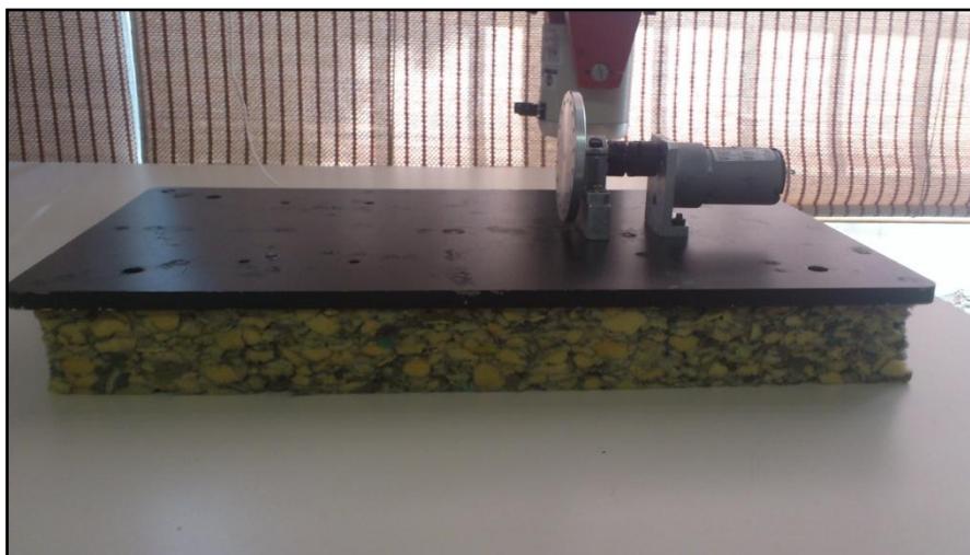
Figura 119: Montaje de Placa sobre panel poliuretano.
