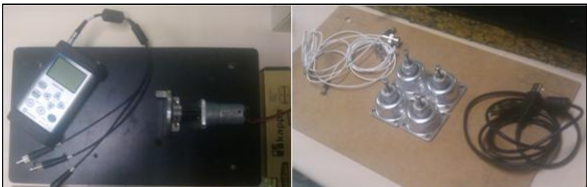
Figura 173: Analizador de vibraciones, conjunto placa-motor, panel aglomerado, plancha de poliuretano y diversos cables.
