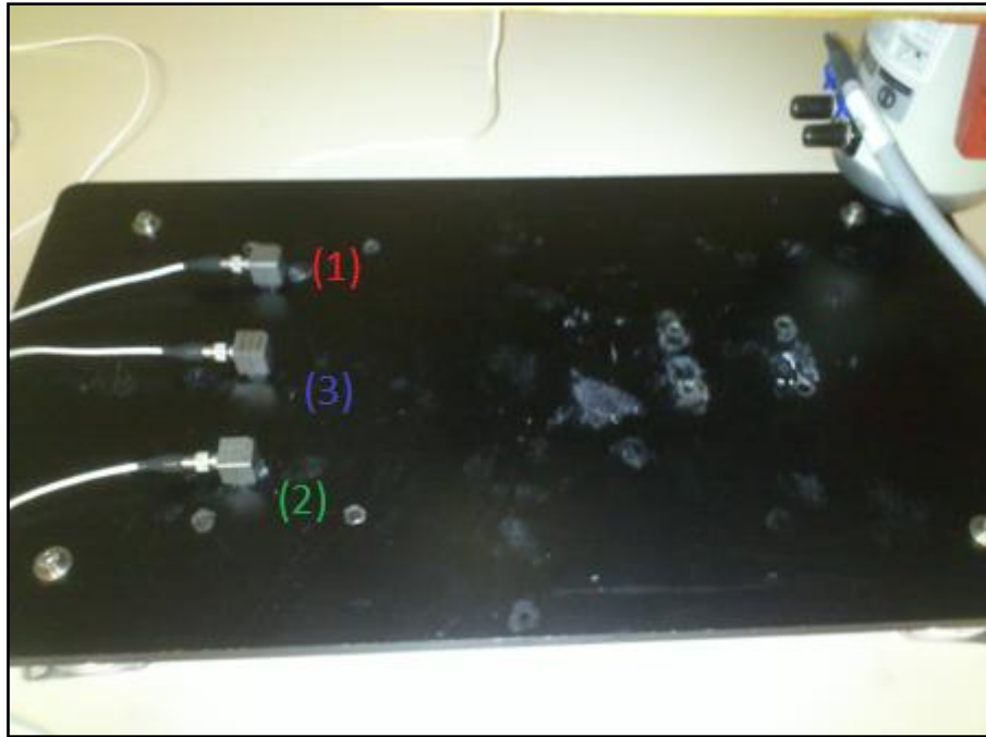
Figura 153: Procedimiento de ensayo para la captación del modo 2,2 mediante un excitador sobre una placa con cuatro muelles, sin el motor fijado a la bancada y tres acelerómetros como instrumentos de medida.
