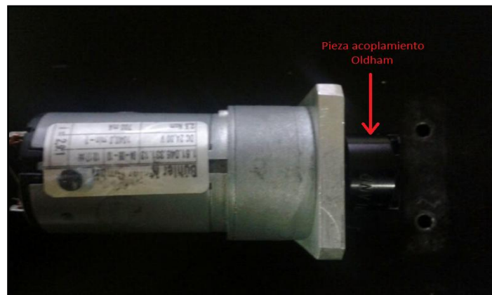
Figura 59: Acoplamiento Oldham sobre el eje del motor.
