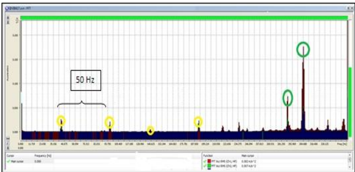
Figura 52: Análisis con acelerómetros encima del motor. Nótese separación de 50 Hz entre picos señalados en amarillo, correspondientes a la frecuencia de línea.
