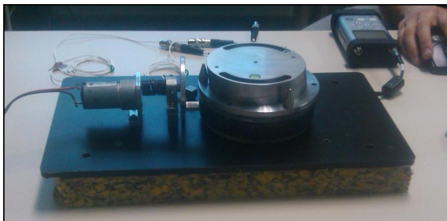
Figura 177: Análisis del sistema placa + motor tras insertar el tablero de aglomerado y la plancha de poliuretano entre la placa y la mesa.
