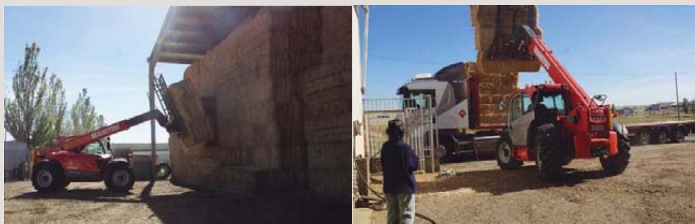
El trabajo de carga consistió en trasladar desde la pila de pacas un total de 63 macropacas, realizando doce ciclos con un carga de cuatro pacas y cinco ciclos transportando tres pacas.
