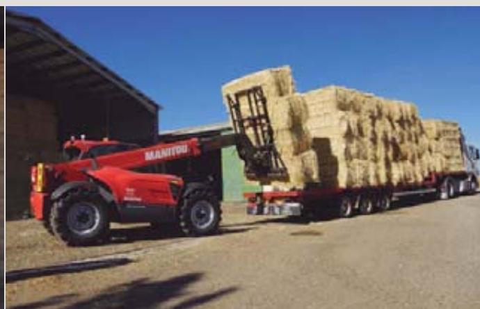
El recorrido acumulado de transportes de pacas fue de 753,7 metros y el peso del conjunto de pacas cargadas en el camión fue de 18.800 kg, con una capacidad de trabajo de la máquina de 65 t/h.
