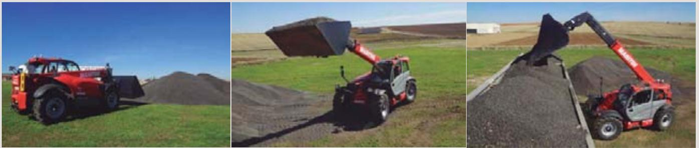
Se trabajó en la labor de carga de pipas de girasol trasladando de la era al camión en dos operaciones un total de 21.240 kg y 21.580 kg con capacidades de trabajo de 87,9 t/h y 83,5 t/h, respectivamente, según el modo de gestión de la transmisión: manual o automática.
