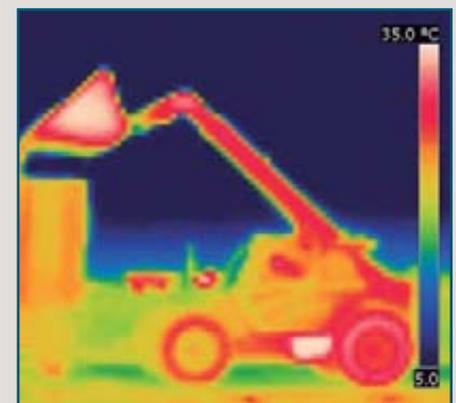
El trabajo hidráulico realizado por los distintos elementos de la cargadora genera calor, con lo que se produce el calentamiento del aceite. Este calentamiento es apreciable en la figura 5, adquirida con una cámara térmica y en la que destaca la superficie del depósito de
