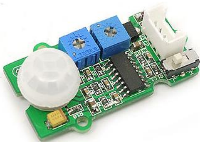
Figura 35. Módulo con sensor PIR
