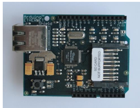
Figura 22. Arduino Ethernet Shield. Imagen extraída de [30]
