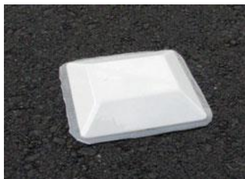
Figura 16. Sensor a nivel de calle [19]
