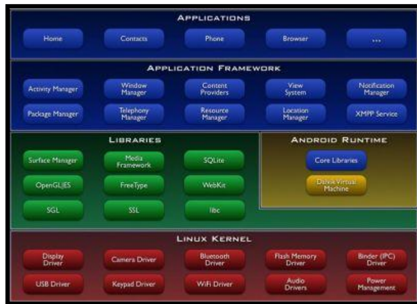
Figura2.2: Arquitectura del sistema operativo Android
