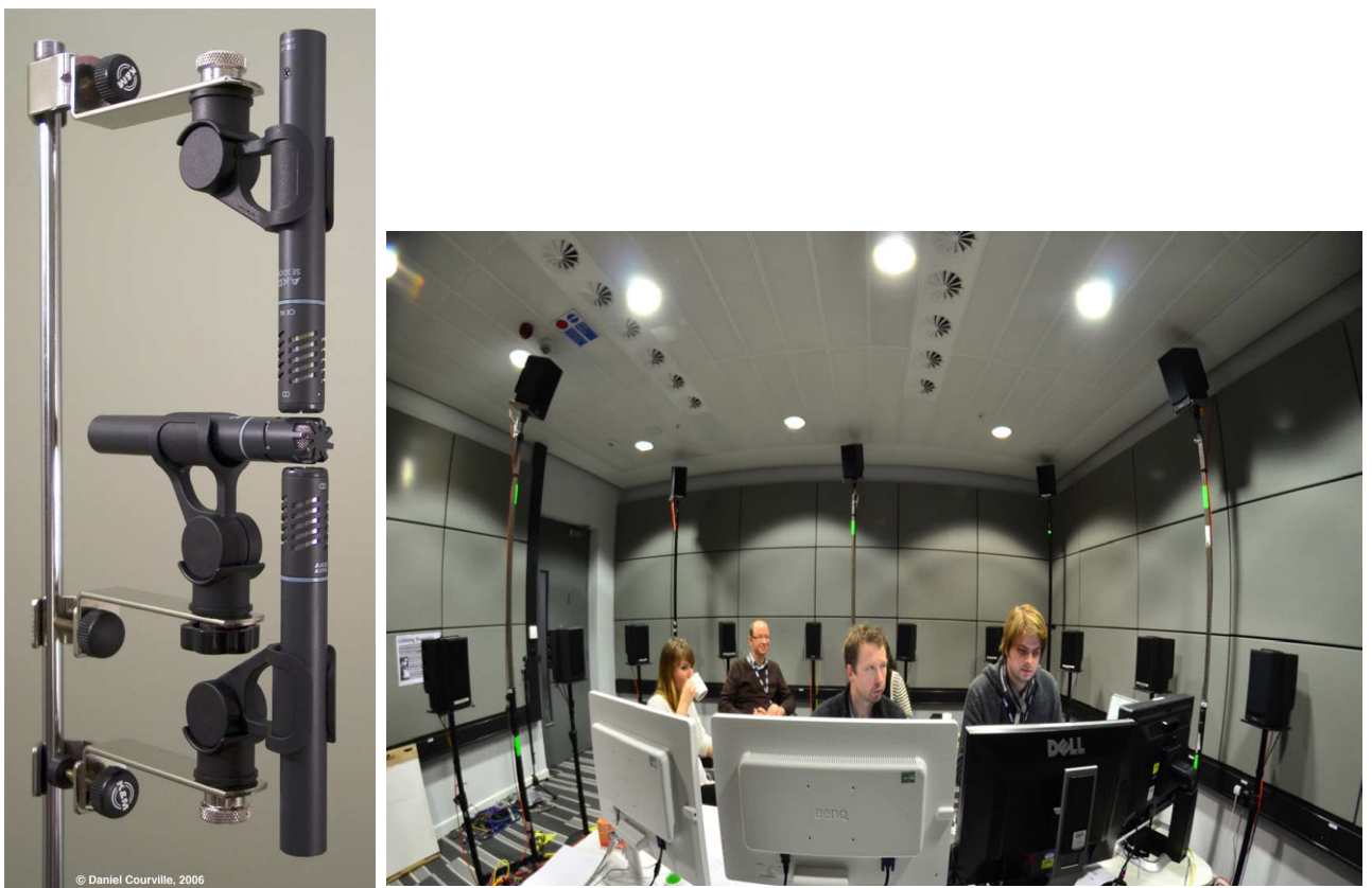
Figura 2.4. Disposición microfónica (dos micrófonos bidireccionales y uno omnidireccional) y sala de escucha compatibles con Ambisonics.
