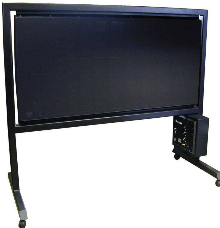
Figura 8.2. Altavoz electrostático dispuesto horizontalmente.
