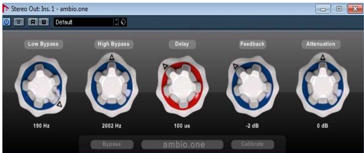
Figura 9.5. Interfaz gráfico del plug-in VST AmbioOne donde se ve la posibilidad de ajustar los parámetros del algoritmo de cancelación de diafonía.
