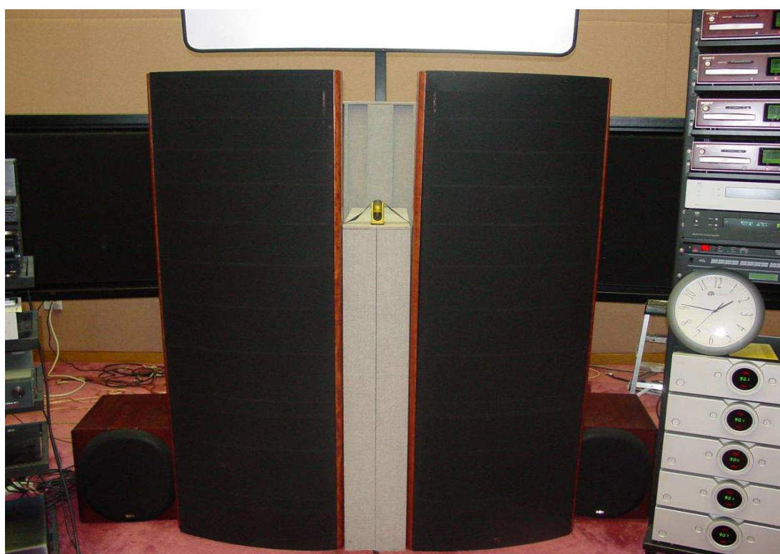
Figura 8.1. Pareja de altavoces centrales electrostáticos para un sistema ambiofónico.
