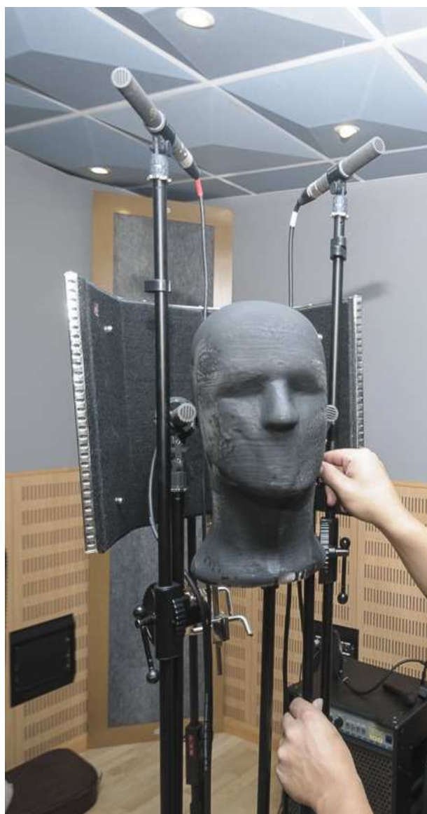
Figura 9.4. Detalle de la posición relativa del ambiofónico y el par estéreo A-B.
