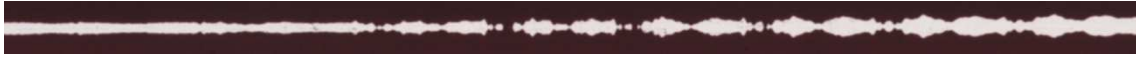
Figura 34: Forma de onda del audio contenido en un fotograma de la película.
