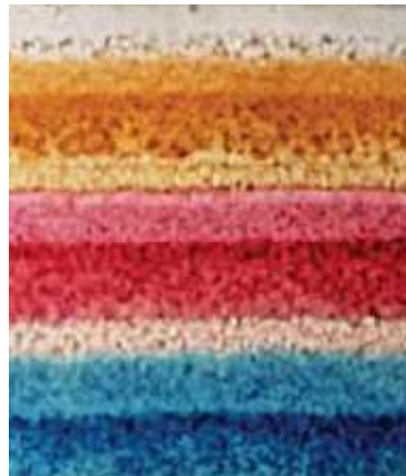
Figura 3: Capas de emulsión con los distintos colorantes en una película para color [3].
