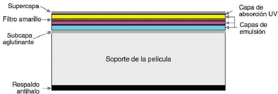
Figura 2: Estructura de la película en función de sus diferentes capas químicas [3].
