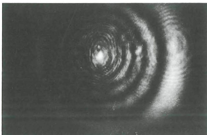
Figura 19. Figura de difracción obtenida en el haz láser de salida después de atravesar una célula de cristal líquido y reorientar a sus moléculas.
