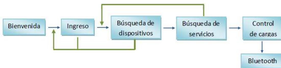
Figura 15. Diagrama de bloques del software Bluelight V2.0 [13]
