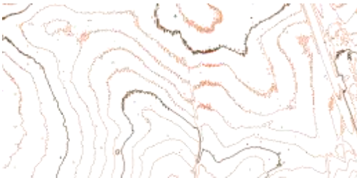
Figura 10: Curvado de una zona entre dos pasadas. En la parte superior se puede observar el ruido introducido por los puntos con pequeñas diferencias. La parte sur corresponde a puntos de una sola pasada. Procedencia propia.
