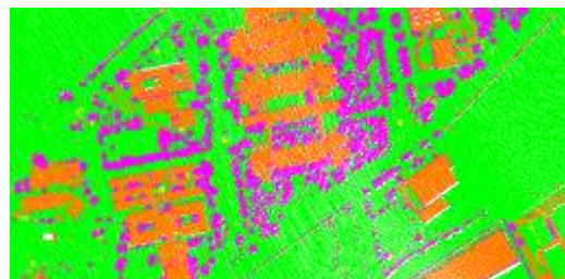
Figura 7: Datos LiDAR clasificados. De color verde los puntos no clasificados o suelo, de color morado la vegetación y de color naranja las edificaciones.
