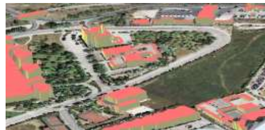
Figura 12: Modelo digital con edificaciones proyectadas y ortofotografía.
