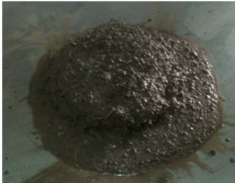
Figura 1. Bloqueo de la masa de hormigón en el anillo J
