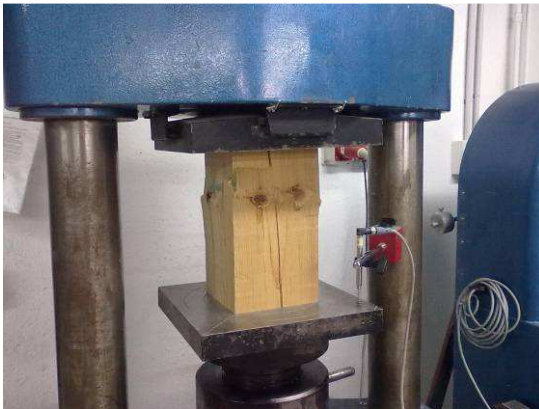
Figura 7. Detalle del ensayo a compresión de una de las piezas
