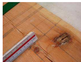
Figura 2. Detalle de medición de nudos.
