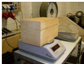
Figura 1. Medida del peso en báscula eléctrica de una de las piezas.
