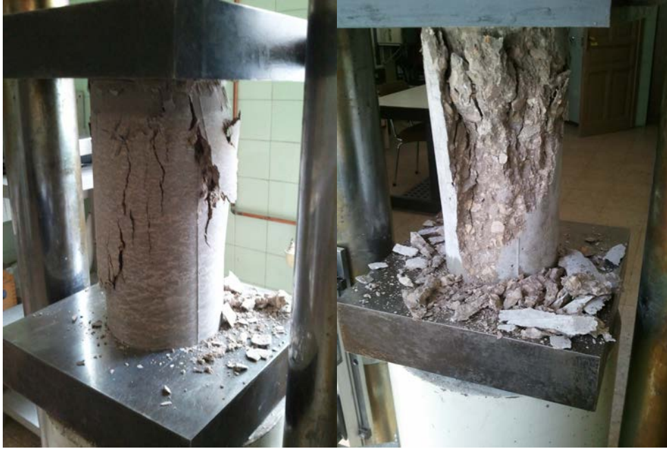
Figura. 6.- Rotura a compresión de probetas de hormigón.
