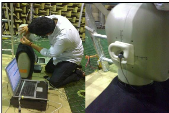
Figura 1 – Calibración de la señal de salida
