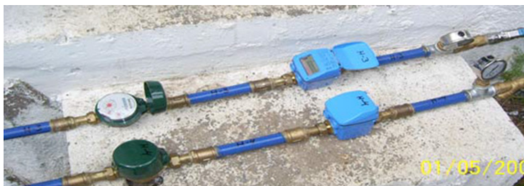
Figura 1; Tren de medida. La carcasa azul corresponde al caudalímetro digital, la carcasa verde oscuro pertenece al caudalímetro de facturación y el manómetro se distingue por la carcasa metálica. (Militello, 2009)
