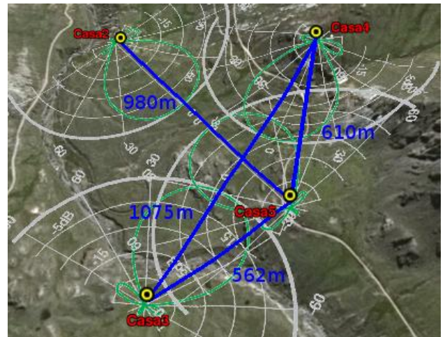
Fig. 1. Topología de la red mallada inalámbrica experimental
