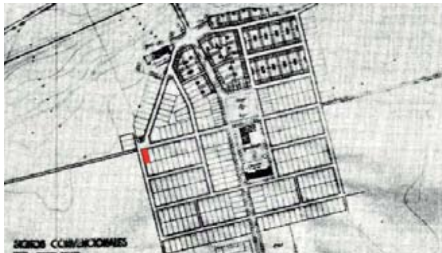
8.117. Propuesta de poblado OPER con parcelas como elemento modular. En este caso los trayectos de conexión tienen asignadas áreas de pertenencia, con lo cual se evitan las calles de testeros ciegos; propuesta del equipo de S. Esteban de la Mora, 1933; por el autor de la tesis sobre imagen de Arquitectura, n.10, 1934.
