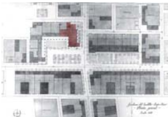
10.66. Organización en planta del conjunto parroquial de Guadiana del Caudillo (Badajoz, 1947) y Pueblo Nuevo del Guadiana (Badajoz, 1952), con la plaza como vacío organizador; del autor de la tesis sobre imágenes del Arch. Minist. Agricultura.
