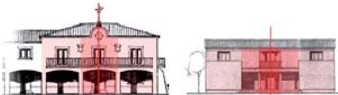
10.47. Composiciones de fachadas modulares tripartitas sin torre: Rucas (Badajoz, 1956) y Los Guadalperales (Badajoz, 1956); esquemas del autor de la tesis sobre imagen del Arch. Minist. Agricultura.
