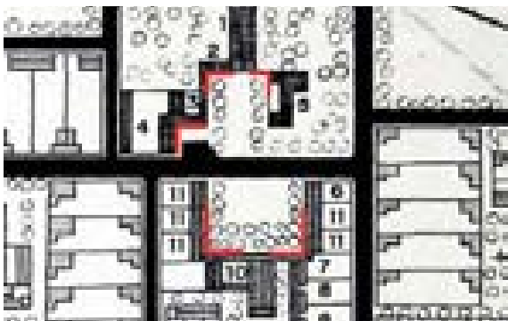
9.61. Cierre visual de la plaza por reconstrucción de los dos diedros de esquina mediante prolongación del pórtico perimetral: Rincón del Obispo (Cáceres, 1955) y Brovales (Badajoz, 1956); por el autor de la tesis sobre imagen del Arch. Minist. Agricultura.
