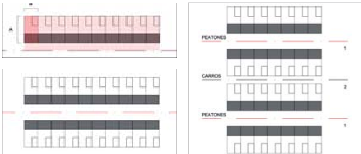
8.121. Esquema de agregación de parcelas en medianera ocupando las áreas laterales de pertenencia de un trayecto y aplicación de la ley de duplicación sucesiva para formar calles paralelas a un trayecto matriz; por el autor de la tesis.
