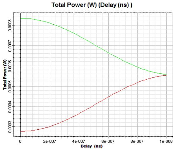
Fig.12. Respuesta del sensor para una corriente constante ( $\theta_F = 15^\circ$ ) en función de la birrefringencia lineal o retardo de polarización entre ejes ortogonales.
