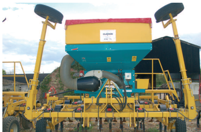
Foto 2. Sembradora Claydon modelo SR de 3,45 m de ancho de trabajo. Drcha: detalle del sistema de protección contra sobrecargas mediante resorte.
