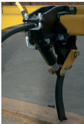
Foto 5. Detalle del sistema de protección contra sobrecargas hidráulico en la sembradora Claydon Hybrid.
