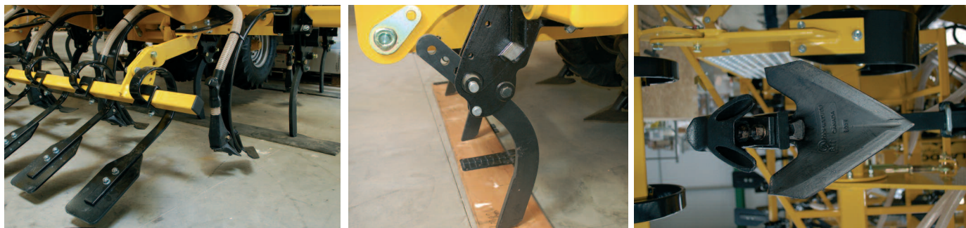
Foto 4. Detalles de las rejas delanteras y traseras y de su disposición en el bastidor de la sembradora Claydon Hybrid.
