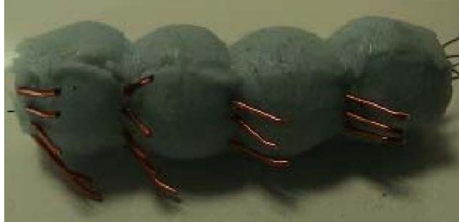
Figura 3.9: Artificial Earthworm - Es un Robot compuesto por cuatro cuerpos de silicona flexible actuados por un muelle SMA con los cuales genera el movimiento peristáltico. Utiliza pequeños alambres metálicos a modo de cilios para sujetarse a la superficie.
