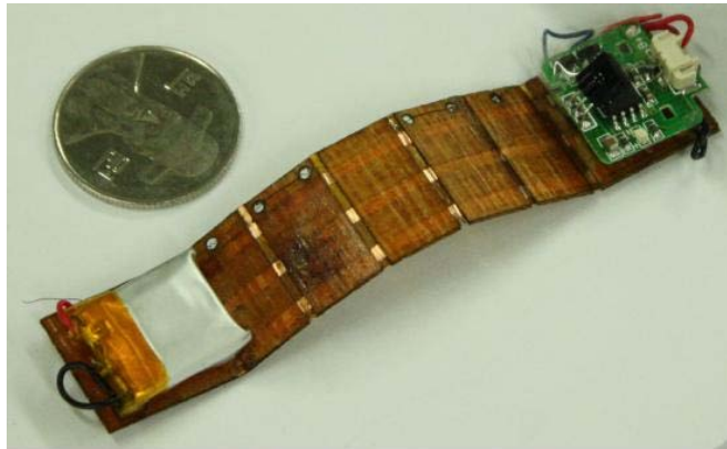
Figura 3.4: Omegabot - Robot tipo oruga desarrollado por la Universidad Nacional de Seoul (Corea), utiliza un compuesto flexible actuado por muelles SMA
