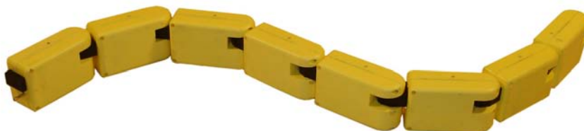
Figura 3.14: AMPHIBOT II - Desarrollado en la EPFL, es un robot anfibio con capacidad de procesamiento de abordo y comunicación inalámbrica
