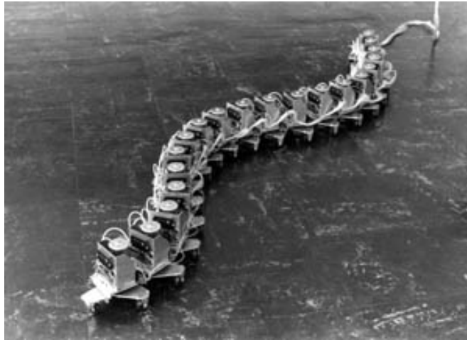
Figura 3.10: Active Cord Mechanism III - El primer robot capaz de reproducir el movimiento de una serpiente, tenía 2 metros de largo y 20 articulaciones actuadas por servomecanismos eléctricos
