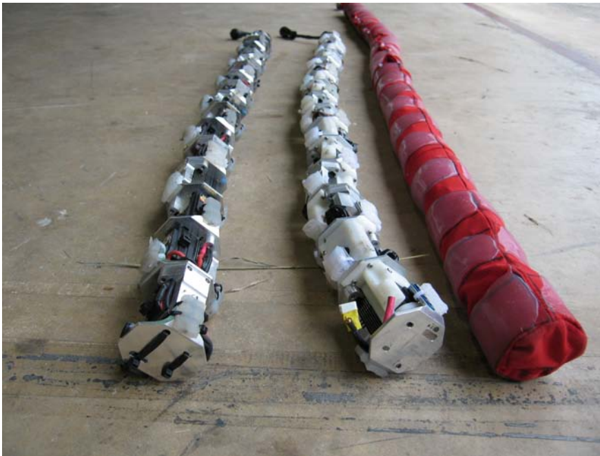
Figura 3.15: CMU ModSnakes - El robot es capaz de realizar diversos gaits , entre ellos ondulación lateral, serpenteo lateral, concentrina, además puede escalar por tuberías o subir escaleras.
