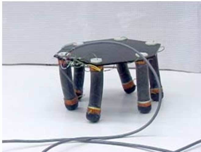
Figura 4.5: Robot MERBot - Es un robot que utiliza articulaciones de 2 GDL basadas en elastómeros dieléctricos en forma de rollo para cada una de sus seis patas (62)
