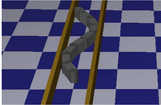
Figura 6.16: Simulación del Robot Serpiente Planar en un Pasillo - Captura de pantalla de la simulación en Webots TM del robot serpiente planar moviéndose en un pasillo
