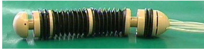
Figura 3.2: InchWorm Prototype - Robot Prototipo Inchworm, posee dos pinzas de sujeción en los extremos que combinan succión y sujeción mecánica y un cuerpo central capaz de expandirse o contraerse utilizando presión de aire pasando de 115 a 195mm
