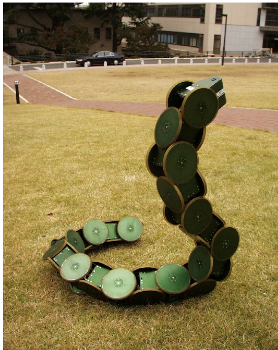
Figura 3.13: Active Cord Mechanism R3 - Robot ACM R3 desarrollado por Hirose, tiene un par de ruedas pasivas por módulo con diámetro superior al tamaño del módulo, lo cual les permite estar siempre en contacto con el terreno, además de realizar movimiento serpentino puede avanzar formando “Ues” o haciendo rotaciones.
