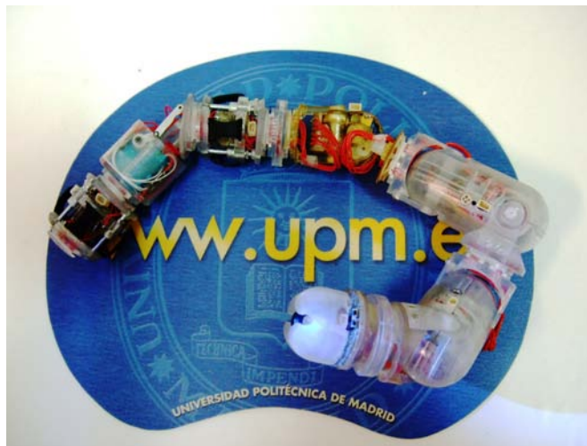
Figura 3.3: Microbot - Micro-Robot modular multiconfigurable desarrollado por la Universidad Politécnica de Madrid, utiliza servomotores y es capaz de moverse por tuberías verticales u horizontales y realizar giros de 90°
