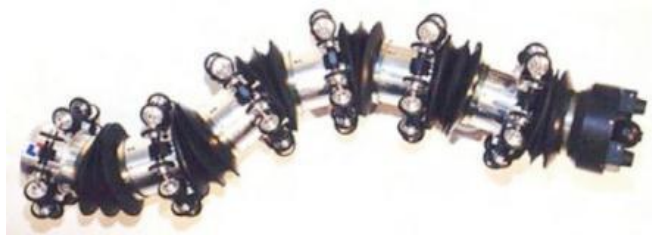
Figura 3.16: GMD Snake 2 - Robot serpentino desarrollado como evolución del modelo tipo serpiente GMD Snake, tiene 10 secciones articuladas con ruedas accionadas por motores eléctricos y capacidad para diversos sensores
