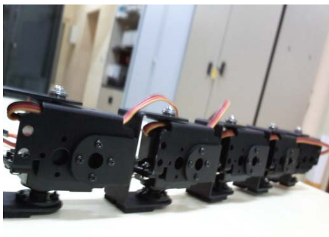
Figura 7.9: Prueba del robot serpiente en configuración planar - El robot serpiente se probó inicialmente en configuración planar, el objetivo era comprobar la capacidad del sistema para realizar la secuencia de movimientos
