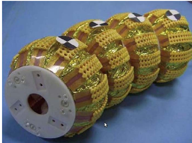
Figura 3.8: Underground Explorer Robot - Es un Robot compuesto por cuatro módulos dónde cada uno es una estructura paralela, es capaz de ascender o descender por tuberías verticales o conductos subterráneos.
