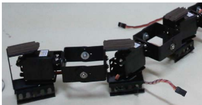
Figura 7.10: Soportes diseñados para mejorar el rozamiento del robot serpiente - Imagen de los soportes agregados en la base de cada módulo para mejorar el rozamiento del robot serpiente durante las pruebas
