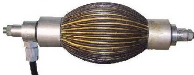
Figura 4.3: Músculo Artificial Neumático - El actuador se comprime cuando la presión neumática en su interior es incrementada y se relaja cuando esta se reduce. Este actuador se utilizó para el desarrollo de un robot bipedo(56)
