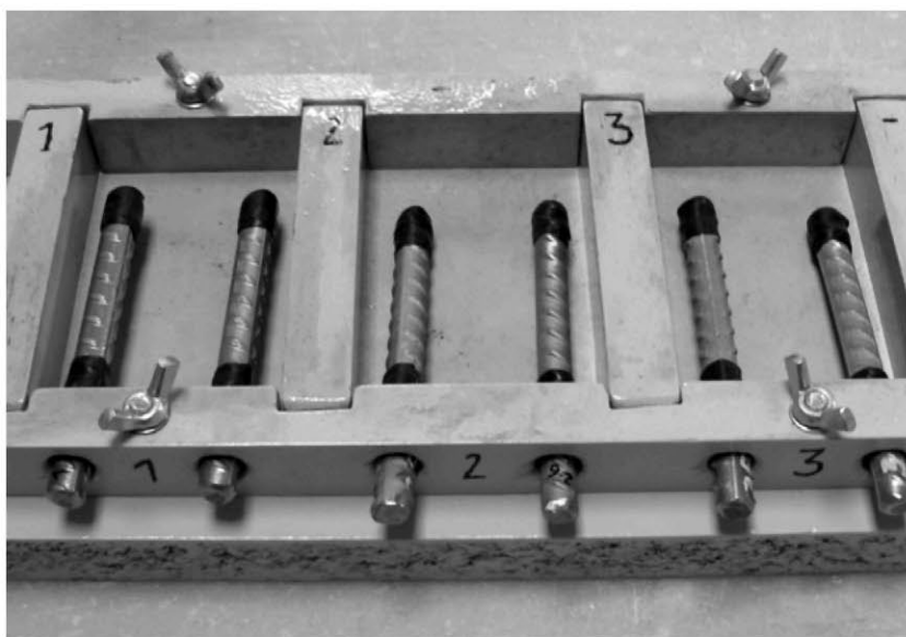
Figura 1 Elaboración de las probetas de mortero diseñadas para estudiar la resistencia a la corrosión por cloruros de las armaduras de acero inoxidable dúplex
