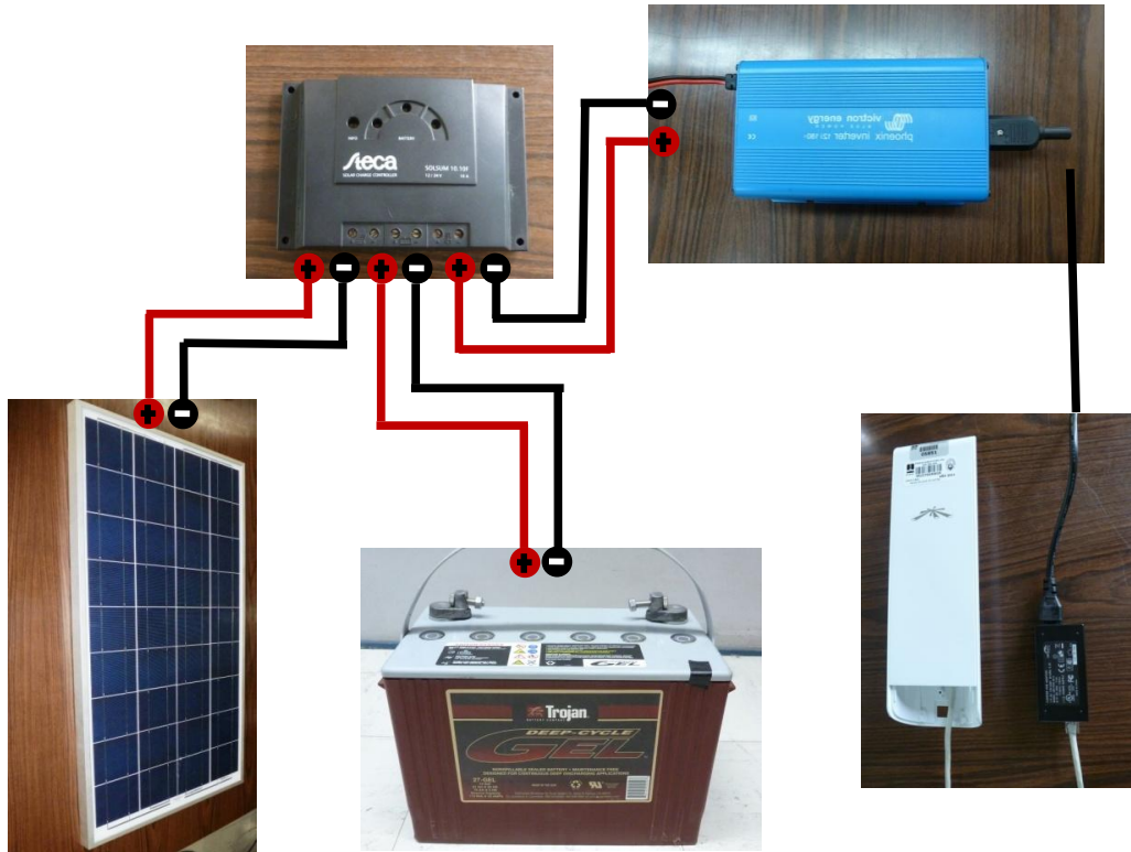
Figura 8. Componentes de sistema fotovoltaico
