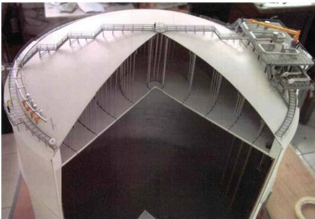
Figura 14 Modelo del techo del tanque
