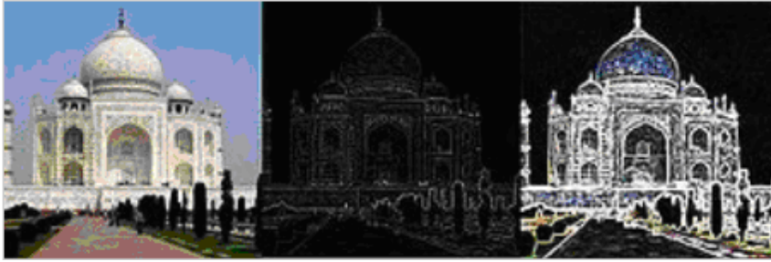
Figura 3.12: Imagen original (izquierda) frente a imagen tratada con el filtro de Canny (centro) y tratada con el filtro de Sobel (derecha)
