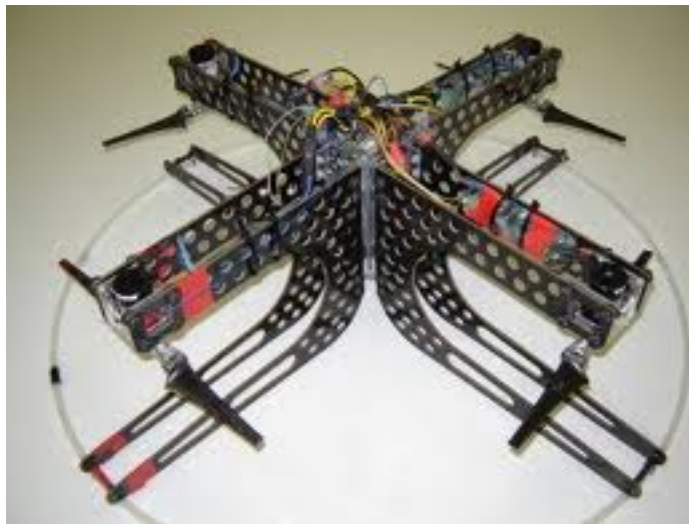
Figura 4.2: Prototipo del quad-rotor X4-Flyer diseñado por Robert Mahony
