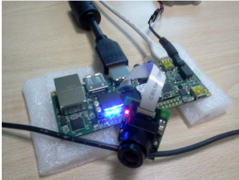
Figura 9.1: Sistema de Visión por computador Gumstix Overo (IronSTORM-Tobi-Caspa)
