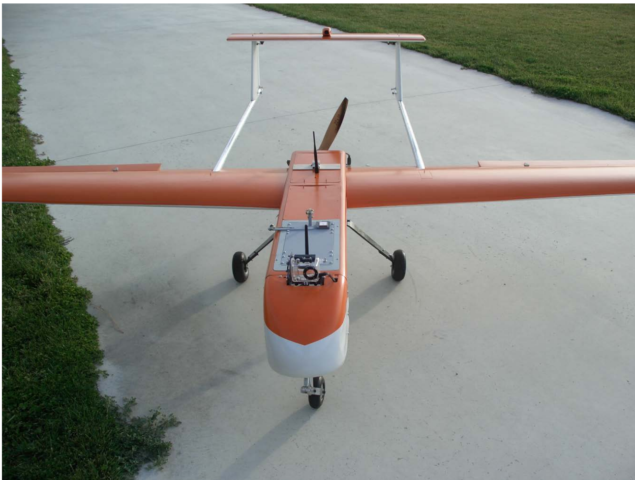
Figura 9.6: UAS Mugin con sistema para la colocación de una cámara en el morro del avión
