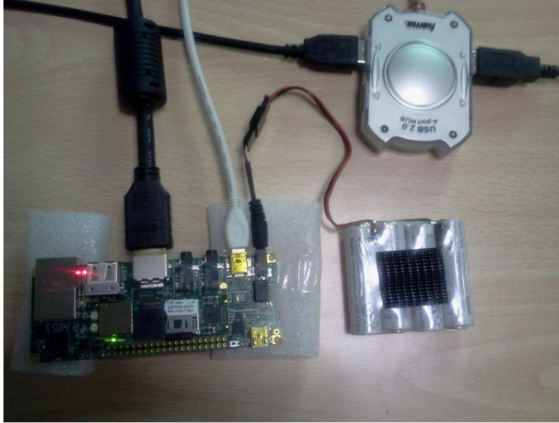
Figura 7.5: Gumstix Overo alimentada por pilas recargables
