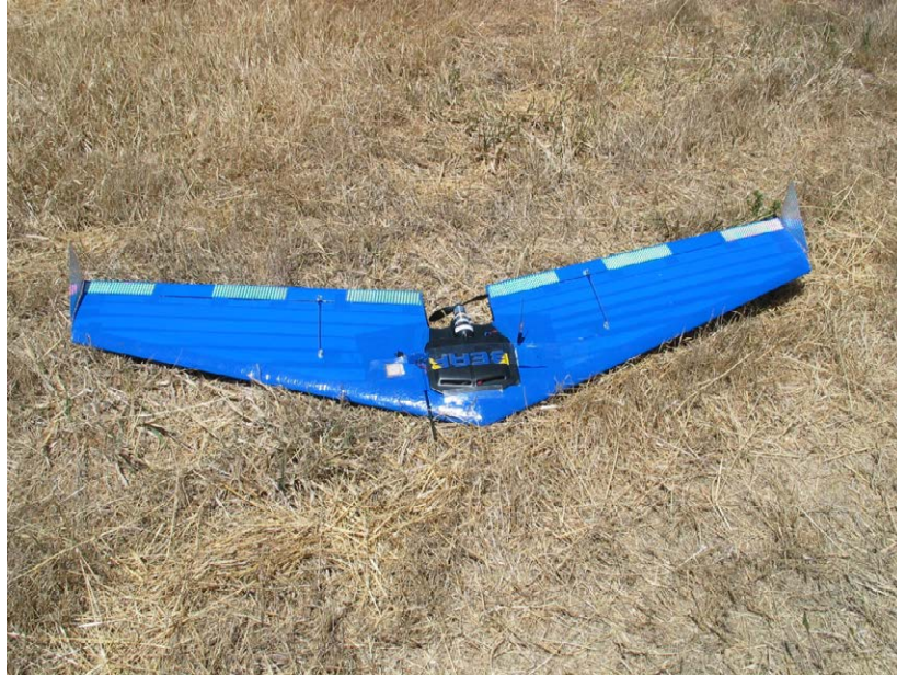
Figura 4.3: SMARTBAT. UAS de ala fija de la UC at Berkeley
