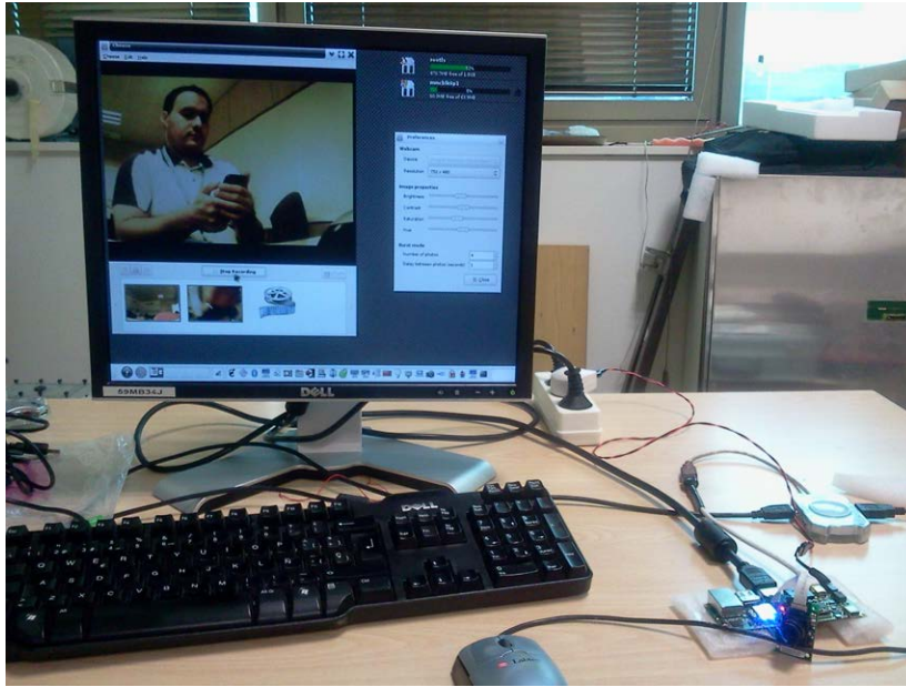
Figura 9.2: Comprobación de funcionamiento del Sistema de Visión por computador Gumstix Overo (IronSTORM-Tobi-Caspa)
