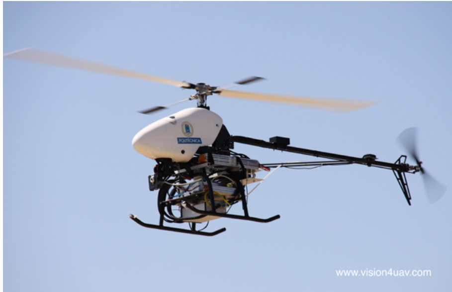
Figura 3.2: Helicóptero COLIBRÍ III, utilizado por el grupo de Vision For Unmanned Systems de la Universidad Politécnica de Madrid
