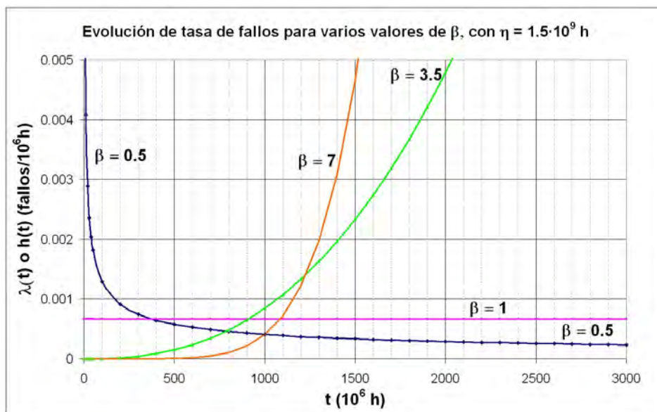
Figura 3.4: Tasa de fallos obtenida mediante la función Weibull con dos parámetros, \eta = 1,5 \cdot 10^9 h, y cuatro valores de \beta , 0,5, 1, 3,5 y 7.
