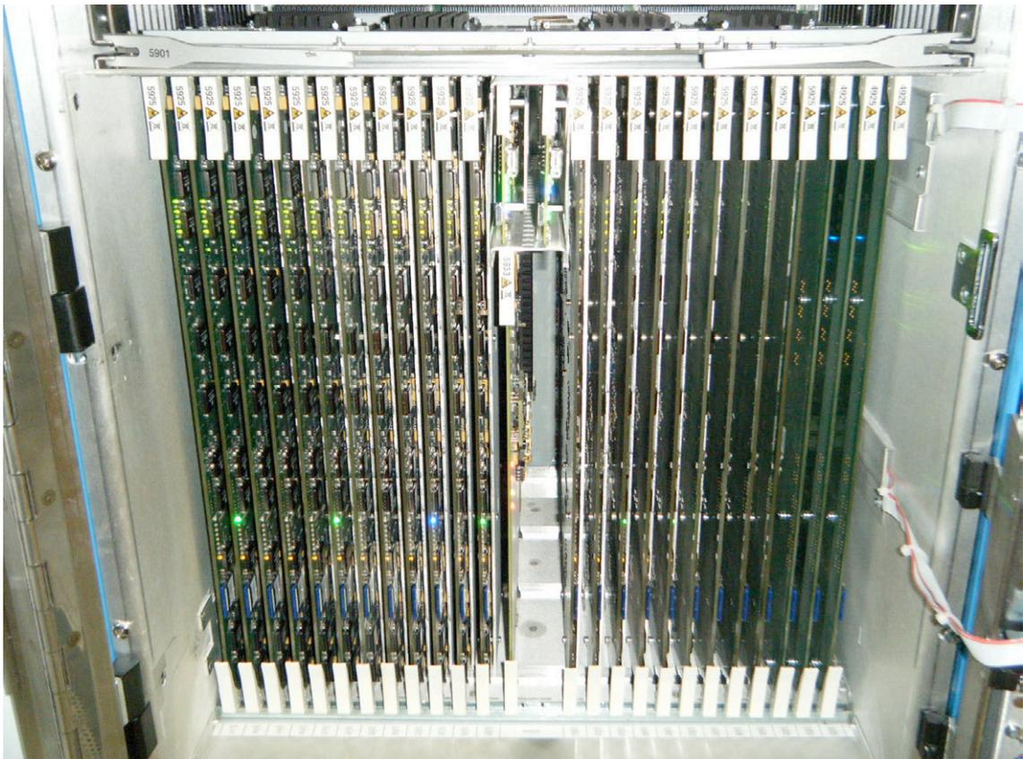
Fig. 45. Tarjetas de salida de video y de audio de la matriz Sirius 850. Por cortesía de RTVE.
