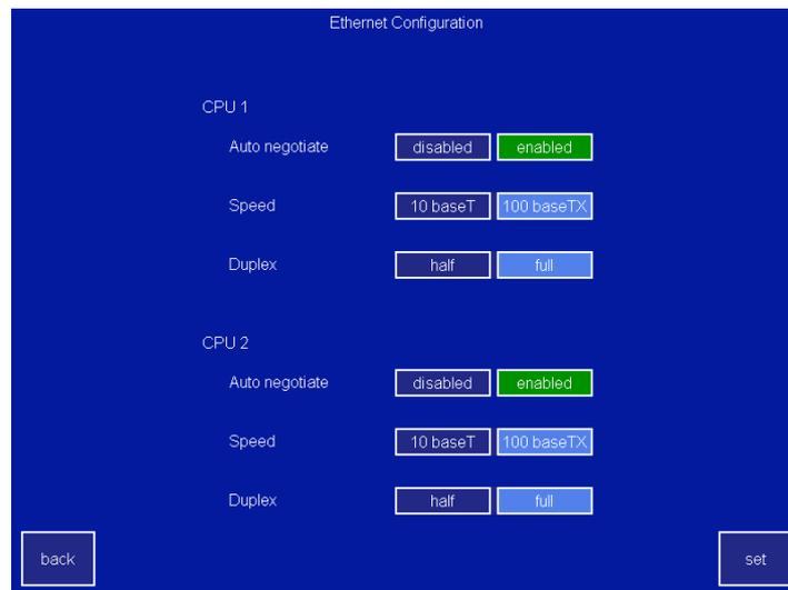
Fig. 206 Configuración del autonegociado de la matriz Vortex. Por cortesía de ETL.
