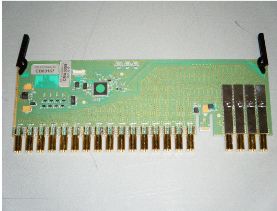
Fig. 185 Tarjeta de salidas de la matriz ETL Vortex. Por cortesía de RTVE.
