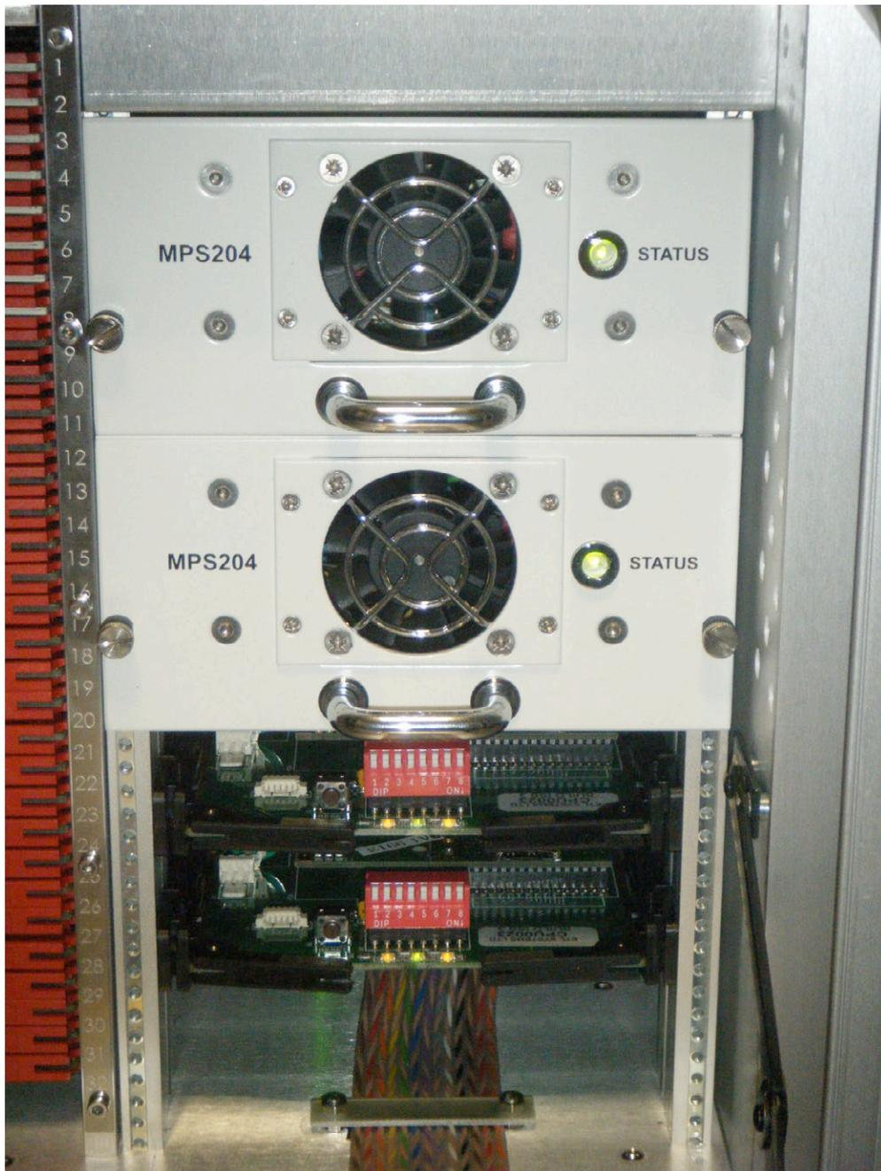
Fig. 159 Fuentes de alimentación y CPUs redundantes de la matriz Nigma. Por cortesía de RTVE.
