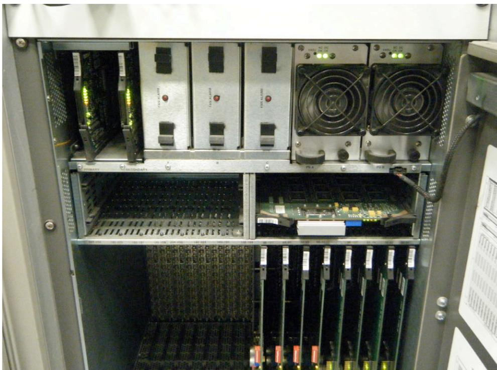
Fig. 21 Dos placas NR-33000, tres ventiladores redundantes y dos fuentes de alimentación redundantes
