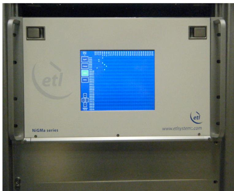
Fig. 147 Frontal de la matriz Nigma 21. Por cortesía de RTVE.
