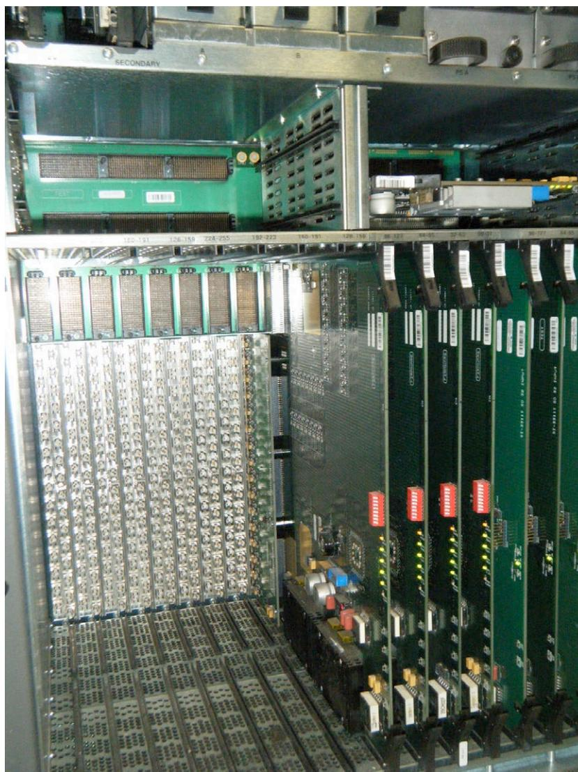
Fig. 12 Tarjetas de entradas, salidas, y conmutación montadas en un chasis por cortesía de Overon.
