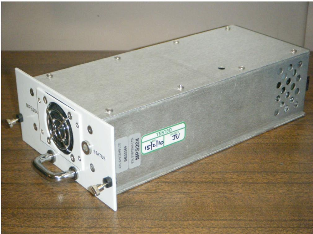
Fig. 154 Fuente de alimentación de la matriz Nigma 21. Por cortesía de RTVE.
