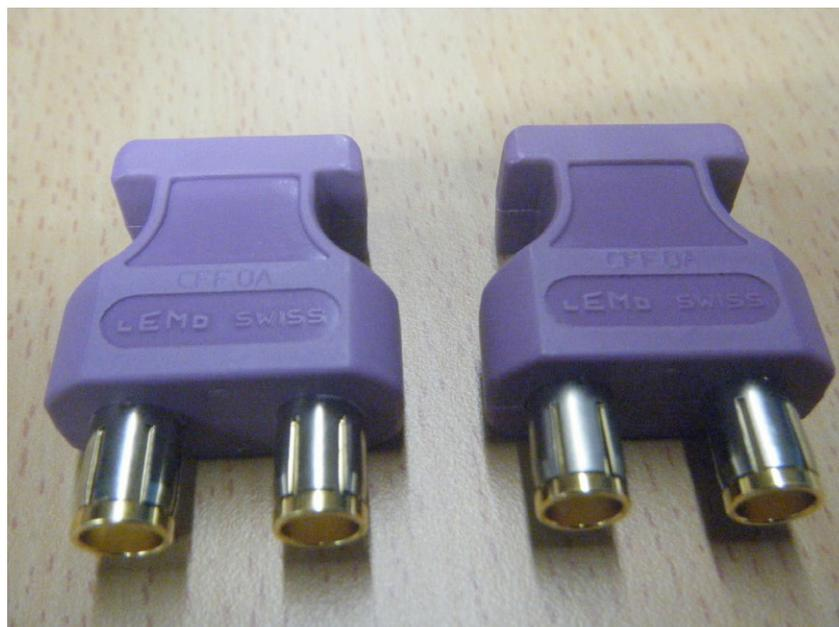
Fig. 142 Puentes de conexionado de Lemo para HD. Por cortesía de RTVE.
