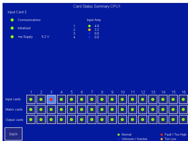
Fig. 195 Pantalla de estado de las tarjetas de entrada. Por cortesía de ETL.
