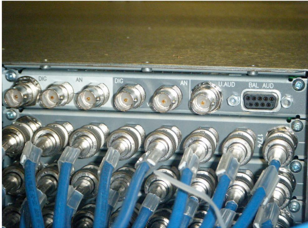
Fig. 17 Tarjeta de monitorado de la matriz Snell Sirius por cortesía de RTVE
