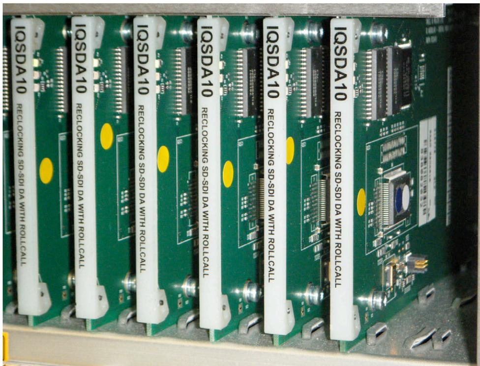
Fig. 97 Detalle de las tarjetas IQSDA10 instaladas en un cofre. Por cortesía de Overon
