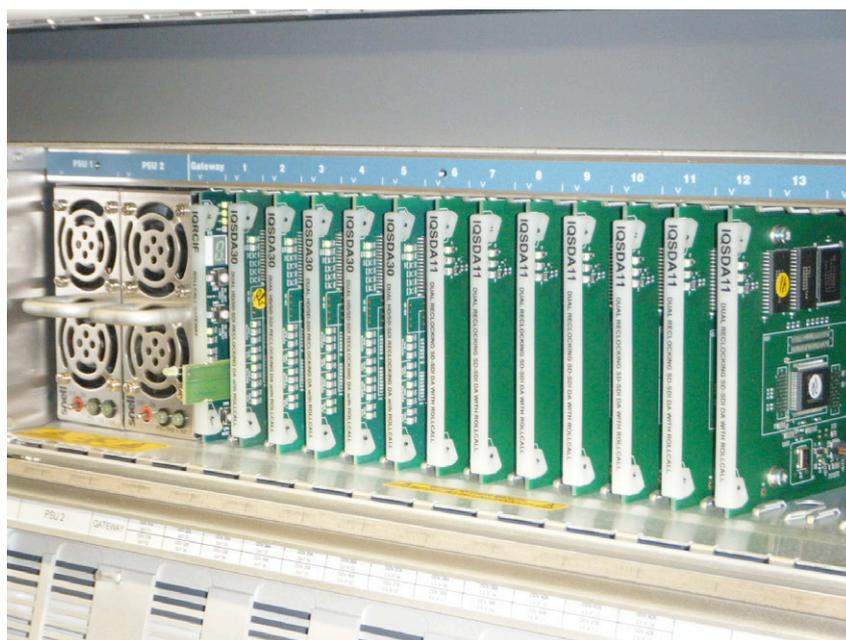
Fig. 130 Cofre de Snell con tarjetas IQSDA30 e IQSDA11. Por cortesía de RTVE.
