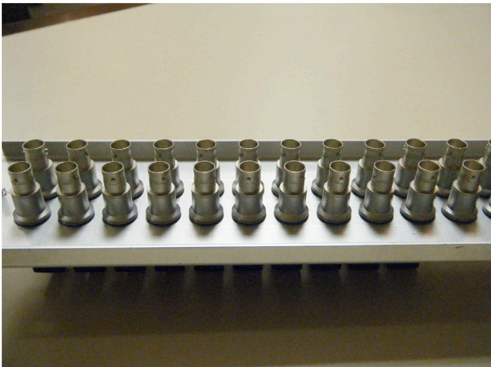
Fig. 132 Trasera de un panel de conexionado. Por cortesía de RTVE.
