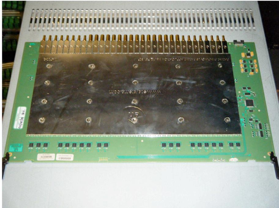
Fig. 184 Tarjeta de conmutaciones de la matriz ETL Vortex. Por cortesía de RTVE
