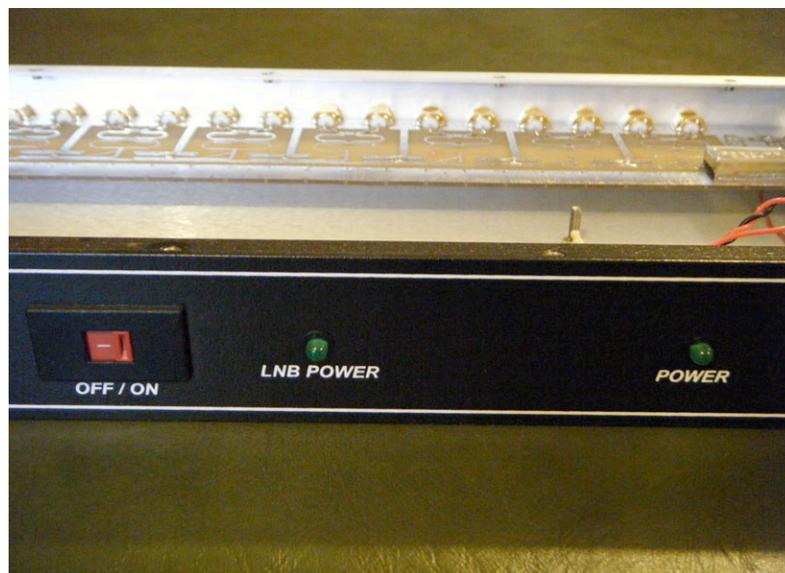
Fig. 234 Vista de los principales elementos externos del splitter Quintech LS 16 2150
