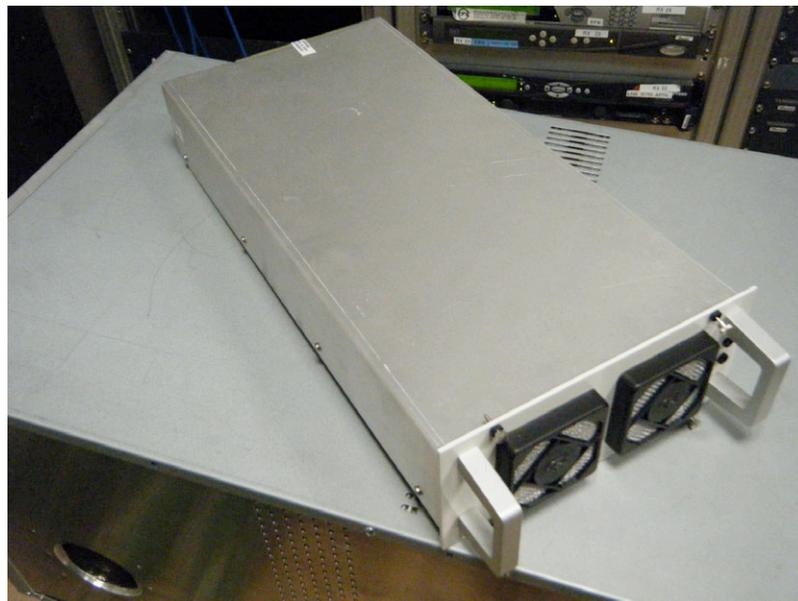
Fig. 182 Fuente de alimentación de la matriz ETL Vortex. Por cortesía de RTVE.
