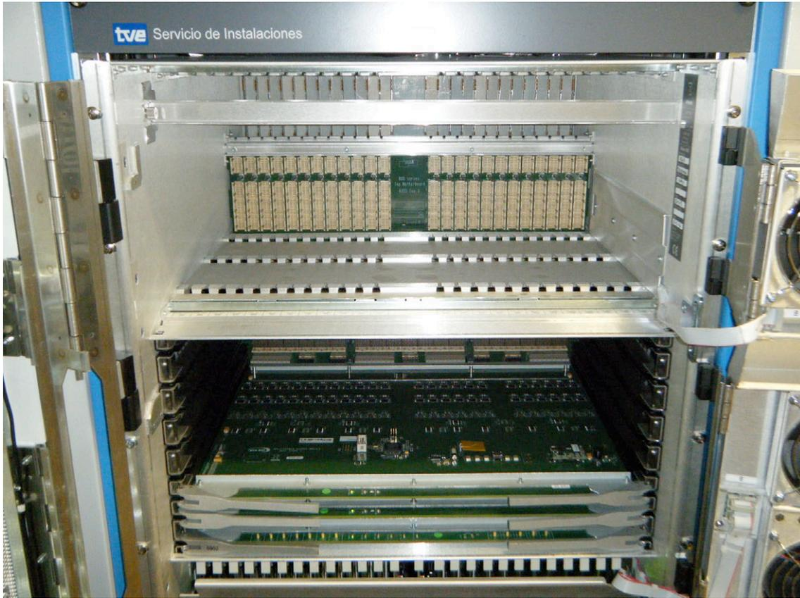
Fig. 42. Tarjetas de monitorado de la matriz Sirius 850. Por cortesía de RTVE.
