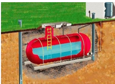
Figura 45. Tanque subterráneo de almacenamiento
