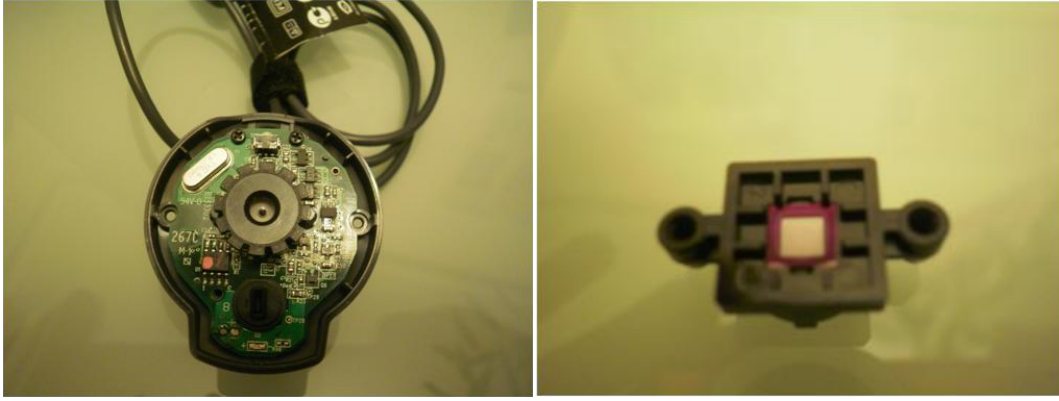
Figura 83. Interior de la cámara web (izq.) y filtro IR (dcha.)
