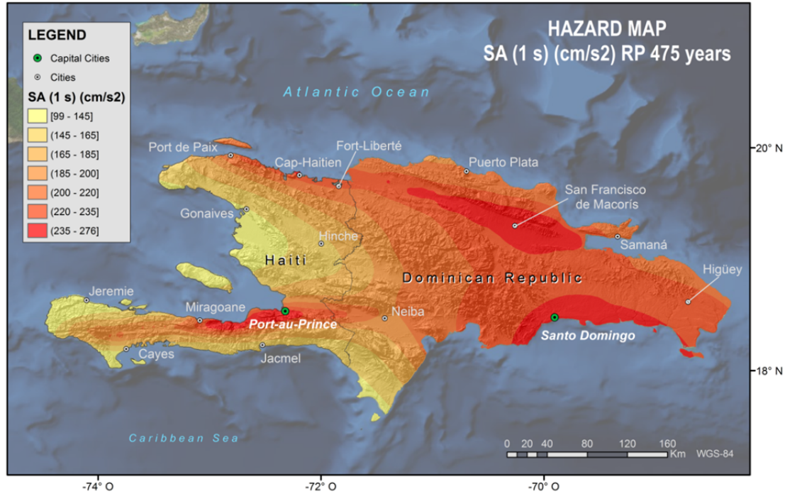
Figure 4-9. Carte de l'aléa sismique en termes de SA (1s) pour PR de 475 ans
