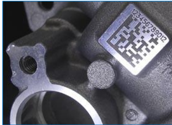
Figura 71: Pieza etiquetada con Datamatrix
