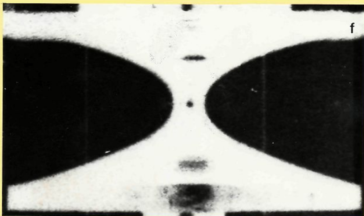
Fig. 8 (Continuación). Rotura de una zona por extracción de líquido manteniendo la esbeltez constante (véase Tabla 9). e - Configuración de la zona (inestable) transcurridos 132 s. f - Última fotografía obtenida antes de la rotura, t=134 s.
