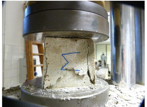
Tensión-Deformación (MORTERO DE CEMENTO)
