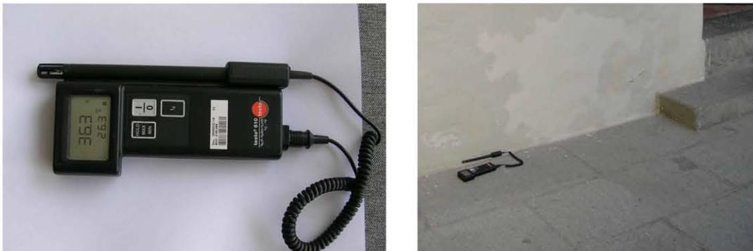
**Figura 1.-** termohigrómetro típico, utilizado en la inspección higrotérmica, y método de toma de datos en puntos de “suelo-pared”
