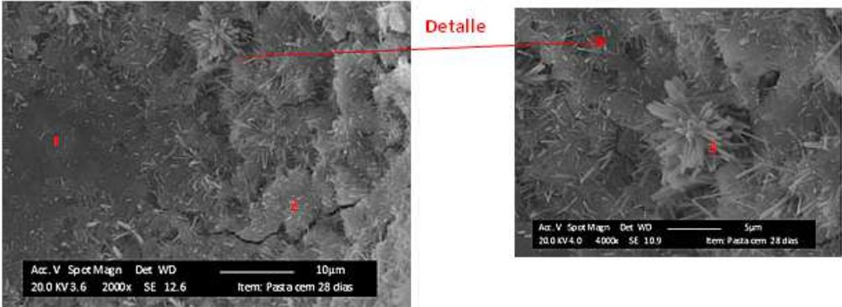
Figura 6. Micrografías de pastas de cemento a 28 días
