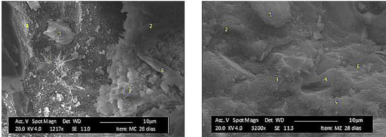
Figura 9. Detalles 1 de los morteros a 28 días. (derecha cemento, izquierda cemento + zeolita)
