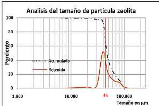
Figura 2. Distribución granulométrica de la zeolita Tasajeras
