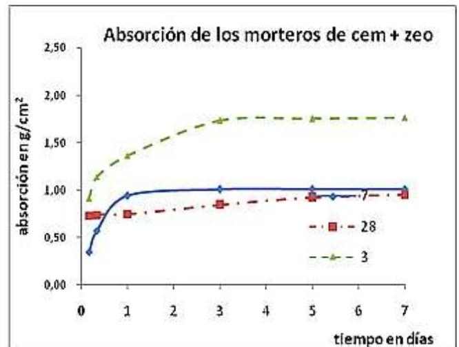
Figura11. Comportamiento de la absorción capilar en el tiempo de los morteros
